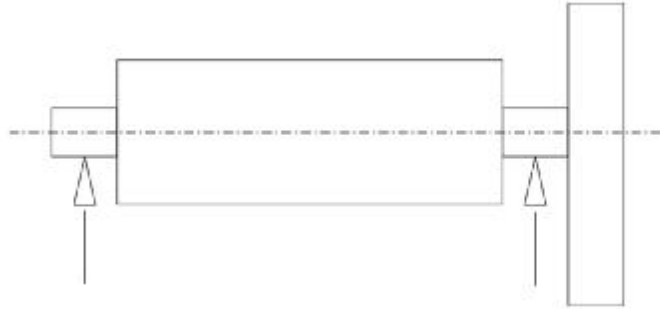
Σχήμα 3.16. Στροφείο με την αζυγοσταθμία έξω από τα ρουλεμάν
