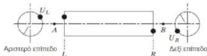
Σχήμα 6.26. Ζυγοστάθμιση δύο επιπέδων
