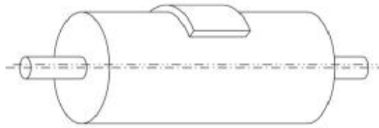
Σχήμα 2.1. Ρότορας με μονή αζυγοσταθμία
