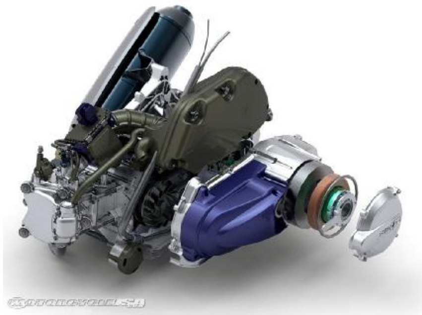
Εικόνα 64. Παράλληλη σύνδεση 4χρονου θερμοκινητήρα με ηλεκτροκινητήρα
