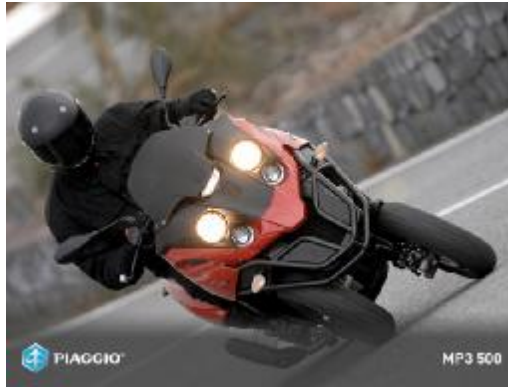
Εικόνα 69. Μεγάλη ευστάθεια σε στροφές λόγω των δυο μπροστινών τροχών
