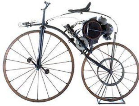
Εικόνα 2. Το δίτροχο «velocipede» των Γάλλων Michaux και Perreaux. Έβαλαν μια μικρή ατμομηχανή, αλλά υπήρχε κίνδυνος ανάφλεξης σε πιθανή πτώση.
