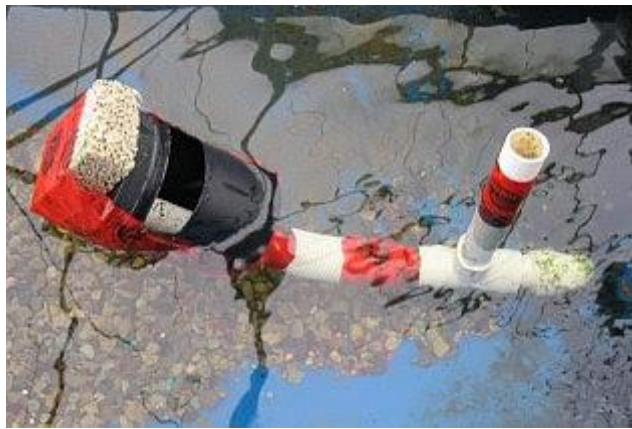
Εικόνα 24. Άξονας εξόδου δεξαμενής (Πηγή: www.backyardaquaponics.com )
