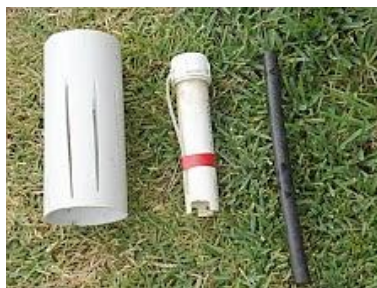
Εικόνα 28. Σιφόνι τύπου καμπάνα (Πηγή: www.aquaponicshq.com )
