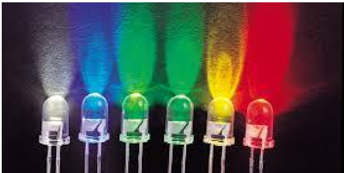
Εικόνα 3.1.7.1 : Δίοδοι εκπομπής ορατού φωτός
