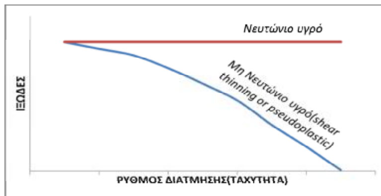
Εικόνα 2.11: Μεταβολή του ιξώδους για νευτώνιο και μη νευτώνιο (ψευδοπλαστικό) ρευστό συναρτήσει του ρυθμού διάτμησης[13]
