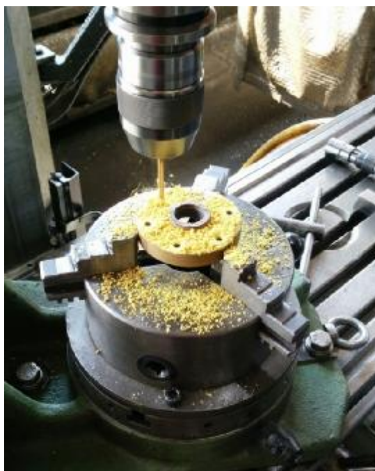
Εικόνα 4.39: Κατεργασία βακελίτη σε φρέζα
