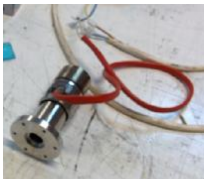
Εικόνα 4.27: Θερμική αντίσταση τύπου δακτυλιδιού συνδεδεμένη με το extruder barrel
