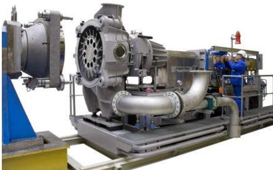
Εικόνα 3.9: Μηχάνημα παραγωγής κόκκων μέσα σε νερό[3]
