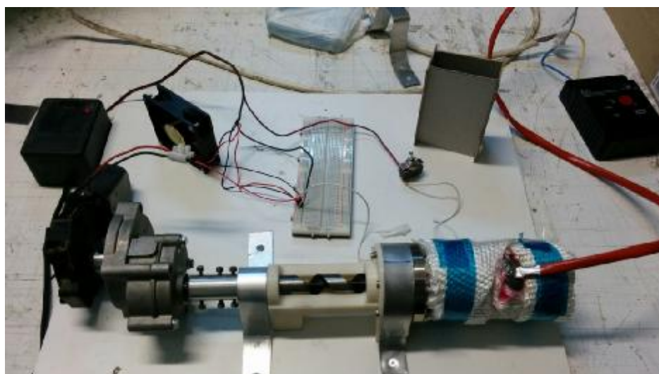
Εικόνα 4.42: Πειραματική διάταξη εξώθησης πολυμερούς LDPE
