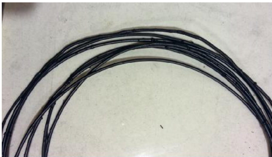
Εικόνα 5.1: Νήμα Custom PA Copolymer 7% CNT με φυσαλίδες κατά την έξοδο του από τον εξωθητή
