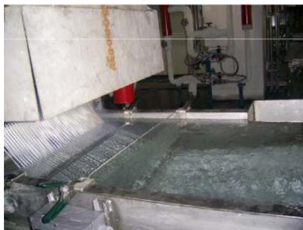
Εικόνα 3.6: Βύθιση νήματος σε νερό[3]
