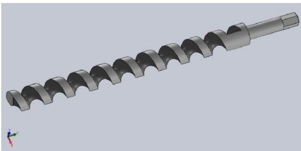
Εικόνα 4.14: Σχέδιο οφιοειδούς τρυπανιού στο solidworks
