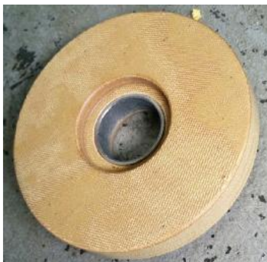
Εικόνα 4.40: Μόνωση βακελίτη με προσαρμοσμένο έδρανο ολίσθησης
