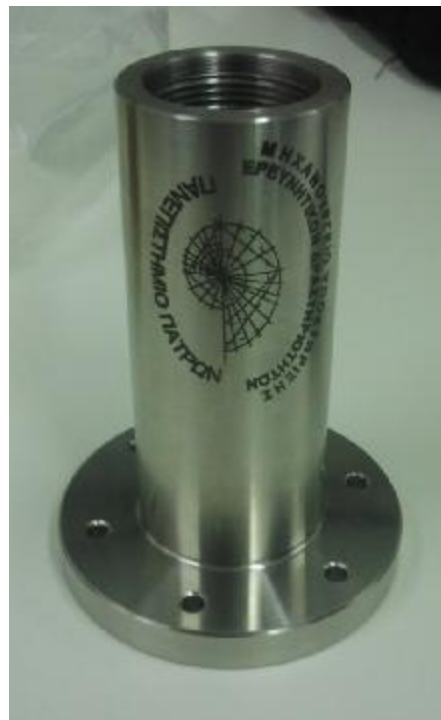
Εικόνα 4.21: Extruder barrel από ανοξείδωτο ασάλι
