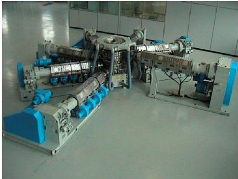
Εικόνα 3.16: Διάταξη συν-εξώθησης για την παραγωγή πολυστρωματικού φιλμ
