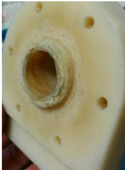
Εικόνα 4.44: Αστοχία πλαστικής (ABS) βάσης
