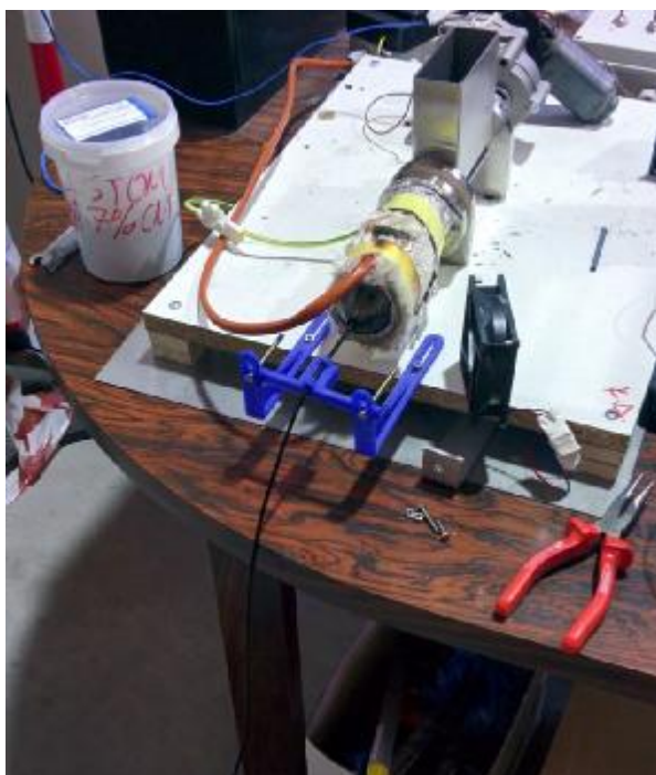
Εικόνα 5.2: Πείραμα εξώθησης Custom PA Copolymer 7% CNT
