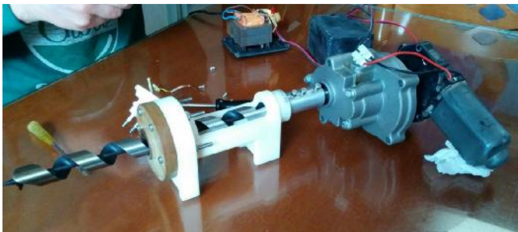
Εικόνα 4.41: Διάταξη εξωθητή με τον κινητήρα, τον μειωτήρα στροφών και τον μετασχηματιστή ρεύματος
