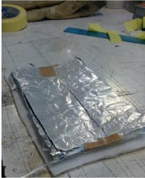
Εικόνα 4.31: Πολυστρωματική μόνωση extruder barrel
