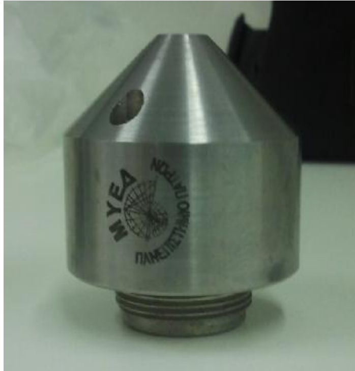
Εικόνα 4.20: Ακροφύσιο από ανοξείδωτο ασάλι
