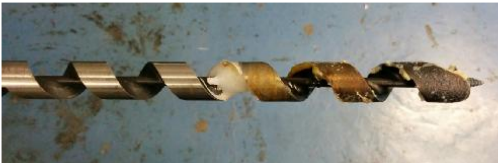
Εικόνα 4.45: Τρυπάνι εξωθητή μετά το πείραμα τήξης
