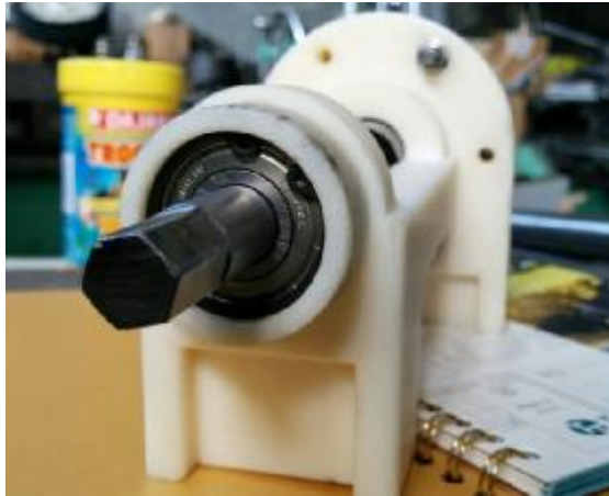
Εικόνα 4.38: Feed barrel με συνδεδεμένο τρυπάνι και έδρανα κυλίσεως
