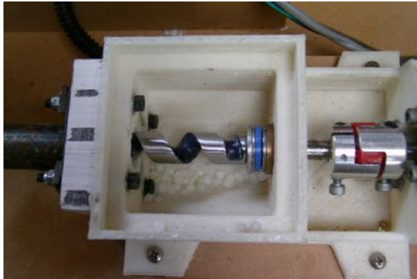
Εικόνα 4.3: Εστίαση στο πρώτο στάδιο της διαδικασίας εξώθησης (βάση/χοάνη και τρυπάνι/κινητήρας)
