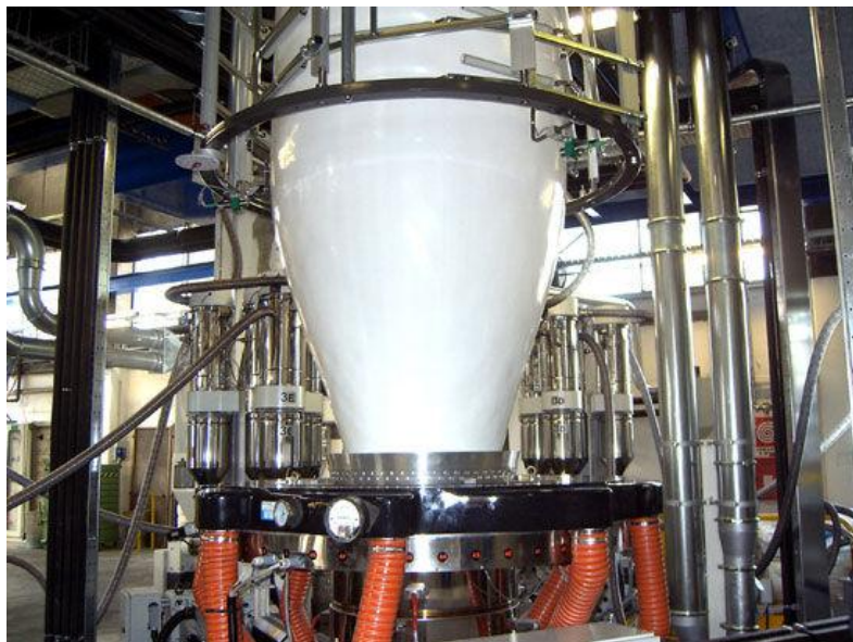
Εικόνα 3.14: Συνδεσμολογία ακροφυσίου και δακτυλιδιού αέρα για τη δημιουργία της φούσκας
