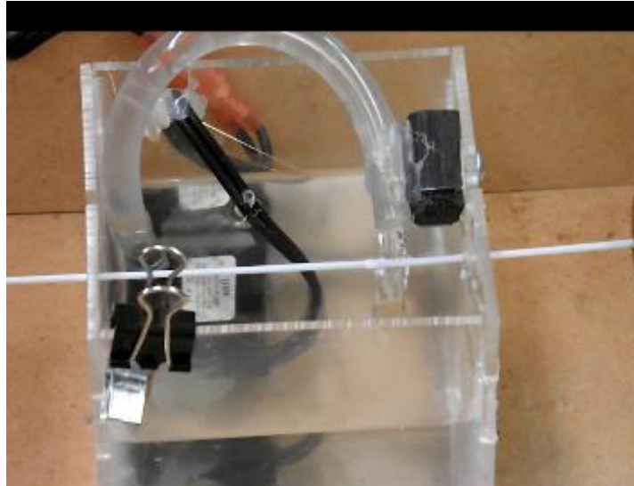
Εικόνα 4.6: Δεξαμενή και αντλία νερού για ψύξη του νήματος
