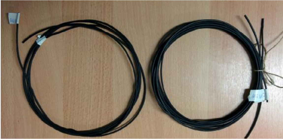
Εικόνα 5.3: Παραγόμενο νήμα PA1502 και LDPE2001
