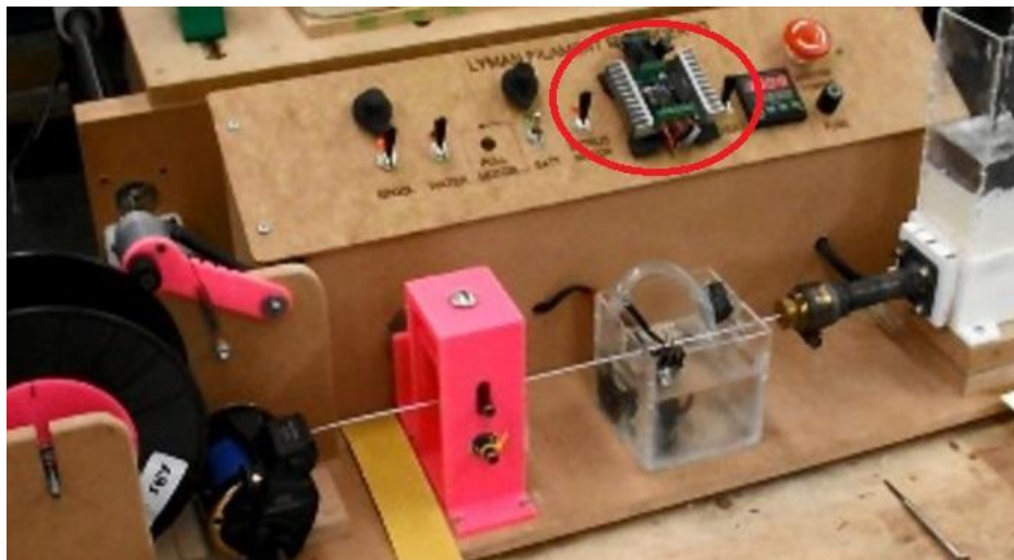
Εικόνα 4.5: Οι Sabertooth & Kangaroo τοποθετημένοι στο πάνελ του εξωθητή
