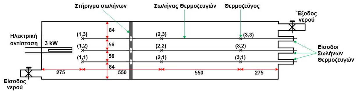
Σχήμα 3.3: Σχηματικό διάγραμμα των θέσεων των αισθητήρων μέτρησης της θερμοκρασίας του νερού εντός του κυλινδρικού δοχείου αποθήκευσης των συσκευών.
