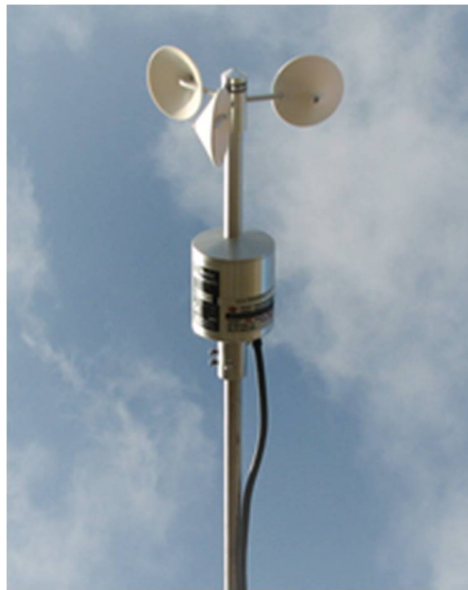
Εικόνα 3.3: Ανεμόμετρο A100LK της εταιρίας Vector.
