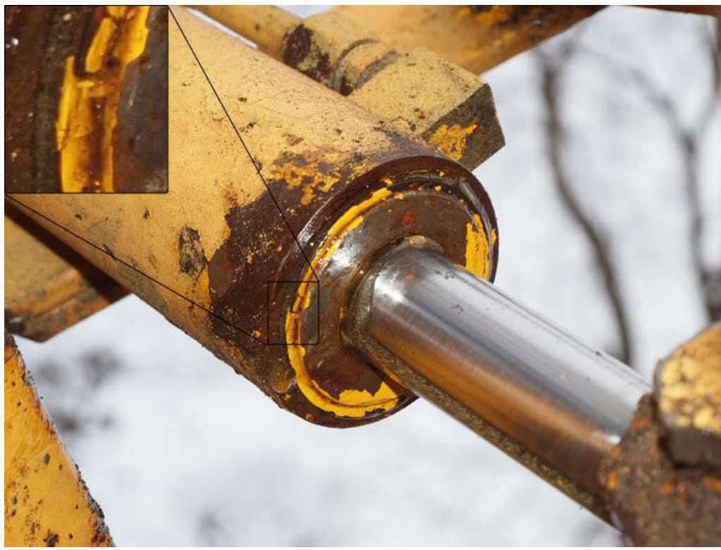
Σχήμα 5.7: Φθορά στο στεγάνωμα μεταξύ κυλίνδρου και πρόσθιου τοιχώματος
