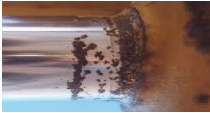
Σχήμα 4.4.1: Διάβρωση στο πρόσθιο τμήμα του κυλίνδρου
