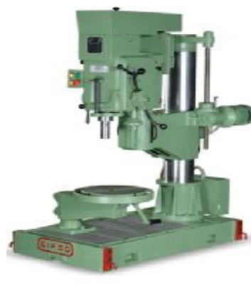
Σχήμα 6.3.1:Δράπανο για διάτρηση
