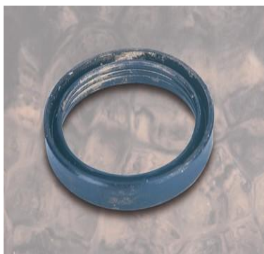
Σχήμα 5.4: Φθαρμένος στεγανωτικός δακτύλιος
