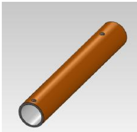
Σχήμα 11.1.1: Κύλινδρος με τις σπές εισαγωγής και εξαγωγής
