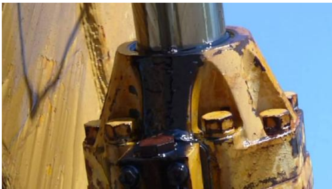
Σχήμα 5.1:Υπερχείλιση λαδιού λόγω φθοράς των στεγανωτικών δακτυλίων
