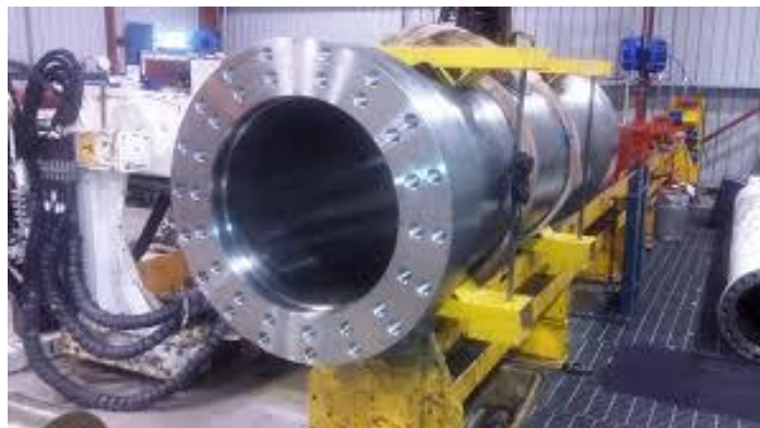
Σχήμα 2.1.2:Κύλινδρος με μεγάλη διάμετρο για μεγάλα ποσά πίεσης
