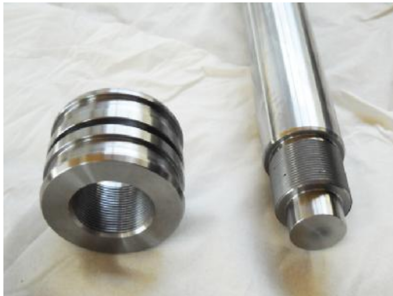
Σχήμα 2.3.2 :Έμβολο με σπείρωμα δίπλα στο βάκτρο του
