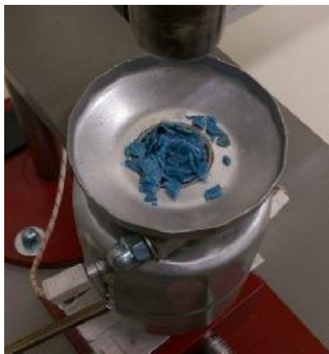
Εικόνα 5.2: Τοποθέτηση πολυμερούς στον αγωγό πλήρωσης
