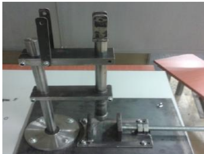
Εικόνα 4.23: Σύνδεση κάτω βάσης με βάση 1, κεντρικού κορμού, μέγγενη, ενδιάμεση βάση, αγωγό πλήρωσης υλικού, μύτη έγχυσης, άνω βάσης, εμβόλου και ελάσματα.
