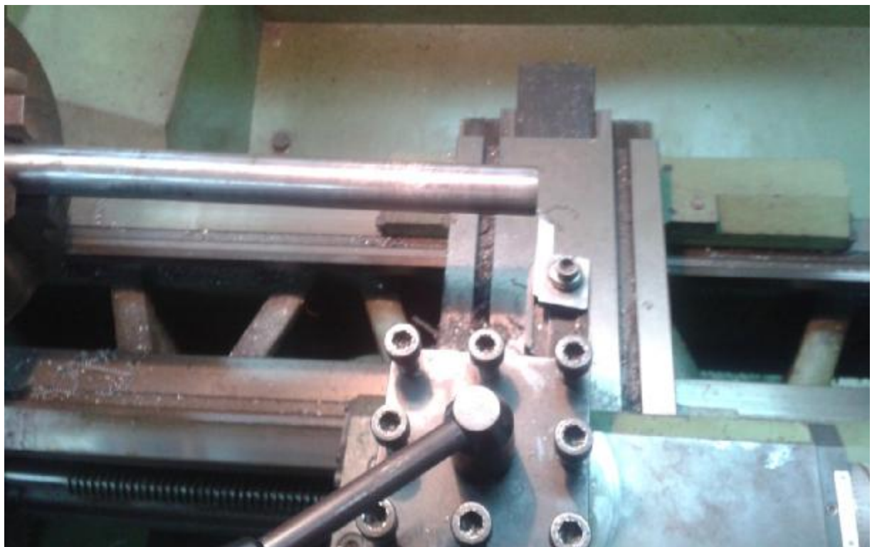
Εικόνα 4.5: Κατεργασία εμβόλου - κεντρικού κορμού.
