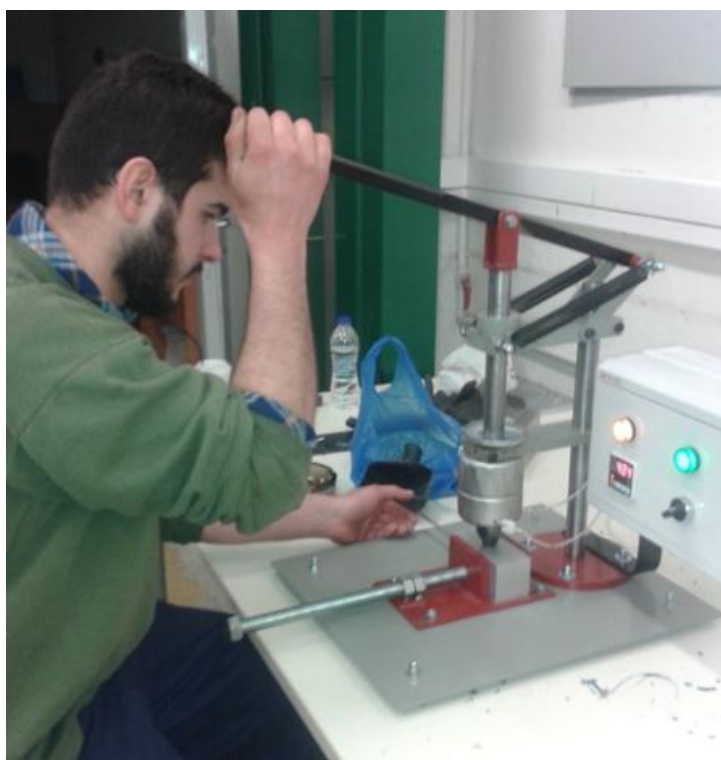
Εικόνα 5.3: Άσκηση πίεσης για την χύτευση τηγμένου υλικού
