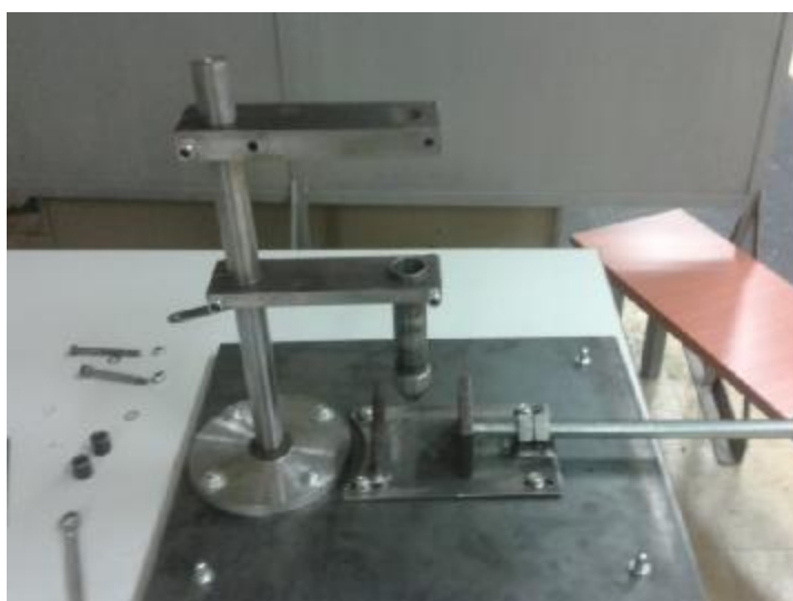
Εικόνα 4.21: Σύνδεση κάτω βάσης με βάση 1, κεντρικού κορμού, μέγγενη, ενδιάμεση βάση, αγωγό πλήρωσης υλικού, μύτη έγχυσης και άνω βάσης.
