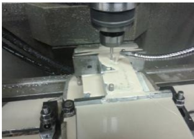
Εικόνα 4.33: Διαδικασία κατεργασίας εσωτερικό καλουπιού.
