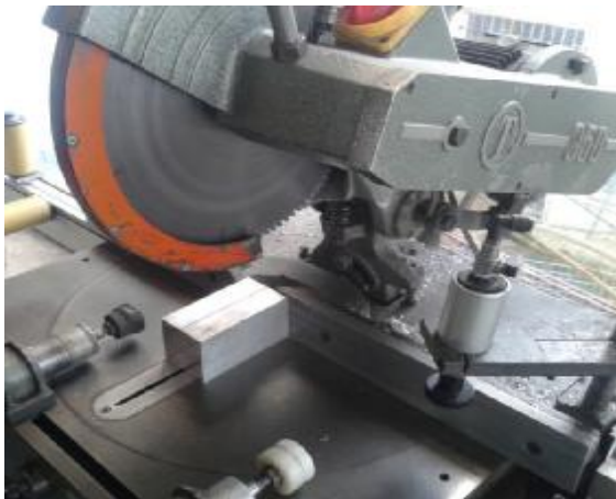
Εικόνα 4.30: Διαδικασία διαίρεσης καλουπιού.
