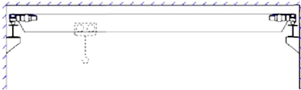
Σχήμα 5.1 : Γερανογέφυρα τοποθετημένη σε κτίριο από σκυρόδεμα.
