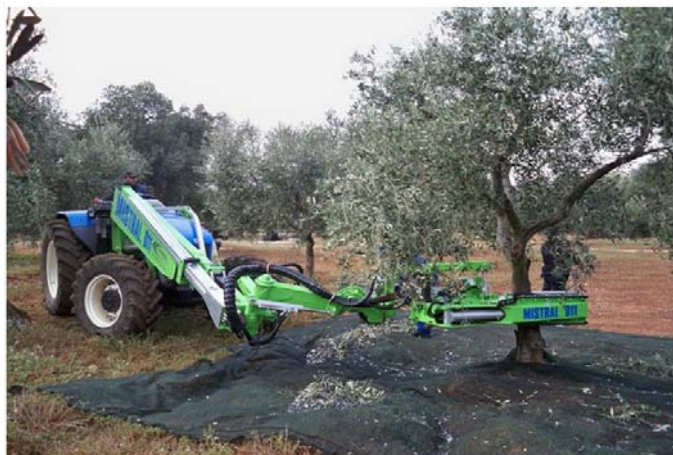
Σχήμα 1.10: Συγκομιδή ελιών με δονητή κορμού. [v]
