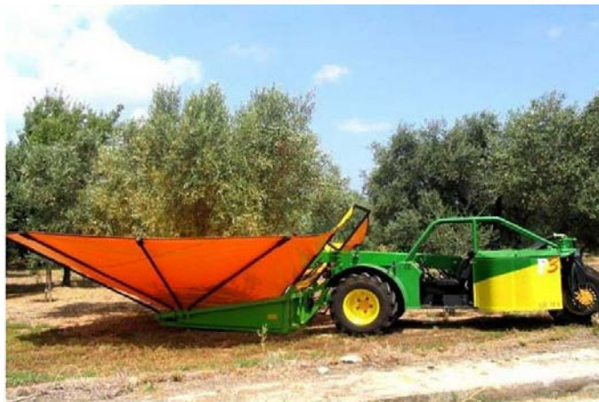
Σχήμα 1.11: Συγκομιδή ελιών με δονητή κορμού με ανάποδη ομπρέλα. [v]
