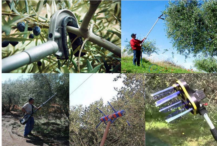
Σχήμα 1.8: Συγκομιδή ελιών με ελαιοραβδιστικό μηχανήμα. [iv]
