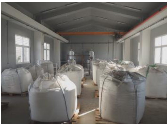
ΕΙΚΟΝΑ 10.9 : ΣΑΚΟΙ ΑΠΟΘΗΚΕΥΣΗΣ ΘΕΪΚΟΥ ΑΡΓΙΛΙΚΟΥ (ΔΕΞΙΑ) ΚΑΙ ΠΟΛΥΗΛΕΚΤΡΟΛΥΤΗ (ΑΡΙΣΤΕΡΑ)
