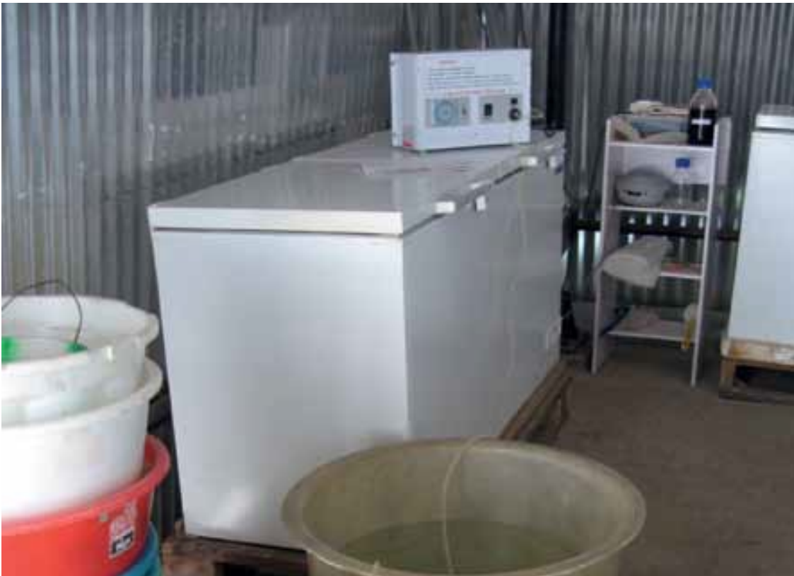
Εικόνα 13. Γεννήτρια όζοντος (πάνω από τον καταψύκτη) και δεξαμενές θαλάσσιου νερού χρησιμοποιούνται για καθαρισμού των αυγών του ροφού. Τα αυγά καθαρίζονται στη μία δεξαμενή (προσκήνιο) και μετά ξεπλένονται σε μια δεύτερη δεξαμενή (εκτός εικόνας) (Φωτογραφία: M. Rimmer)
