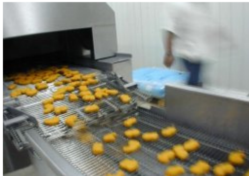
Εικόνα 17. Διαδικασία παραγωγής έτοιμων ψημένων προϊόντων ΠΙΝΔΟΣ. Πηγή: http://www.pindos-apsi.gr/
