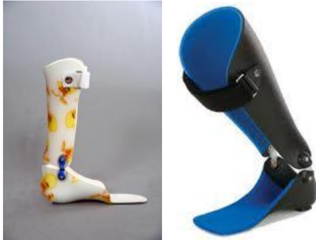
εικόνα 4.10: Κνημοποδικός νάρθηκας αρθρωτού τύπου (hinged- HAFO) με στοπ στην πελματιαία κάμψη που επιτρέπει ελεύθερα την ραχιαία κάμψη της ΠΔΚ, www.google.gr
