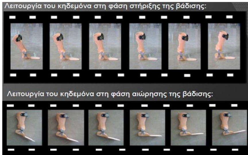
εικόνα 4.11: Λειτουργία του αρθρωτού κνημοποδικού κηδεμόνα στις φάσεις του κύκλου βάρδισης, http://www.dchristodoulou.gr/epirusmed/inform.php
