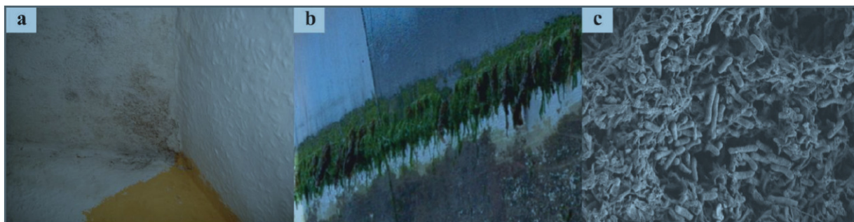
Εικόνα 2.7: (a) Εμφάνιση μούχλας σε σπίτι, (b) ανάπτυξη φυκιών στους υφάλους ενός πλοίου, (c) σχηματισμός βακτηριακού βιοϋμενίου πάνω σε έναν καθετήρα.
