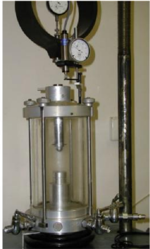
Εικόνα 1.14: Διάταξη τριαξονικής δοκιμής (σχεδιάγραμμα, φωτογραφία)
