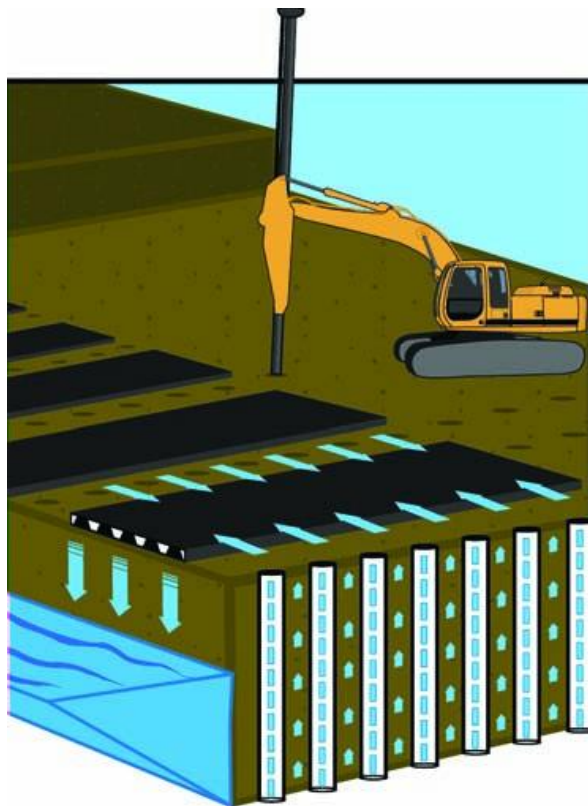
Εικόνα 2.10: Σχηματική διάταξη και τρόπος λειτουργίας των κατακόρυφων συνθετικών στραγγιστηρίων. Η αυξημένη οριζόντια διαπερατότητα και η μικρή απόσταση μεταξύ των πασσάλων περιορίζουν σημαντικά το χρόνο στερεοποίησης
