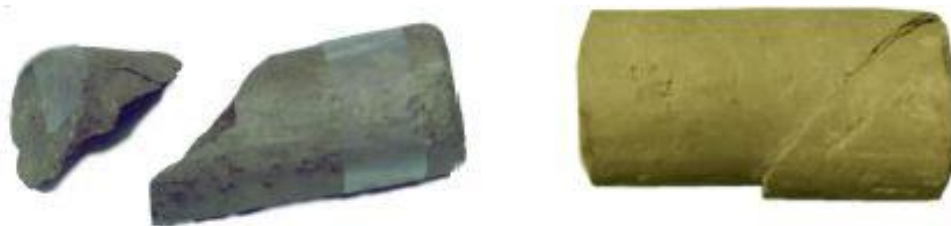
Εικόνα 1.12: Αστοχία δοκιμίου αργίλου από θλίψη. Η αστοχία εκδηλώνεται σε ένα επίπεδο που σχηματίζει γωνία με την διεύθυνση φόρτισης \sim 45^\circ .
