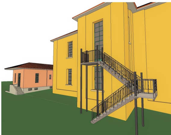
ΕΙΚ. 94 Βόρεια πλευρά του κτηρίου – κλίμακα έξοδου κινδύνου.
