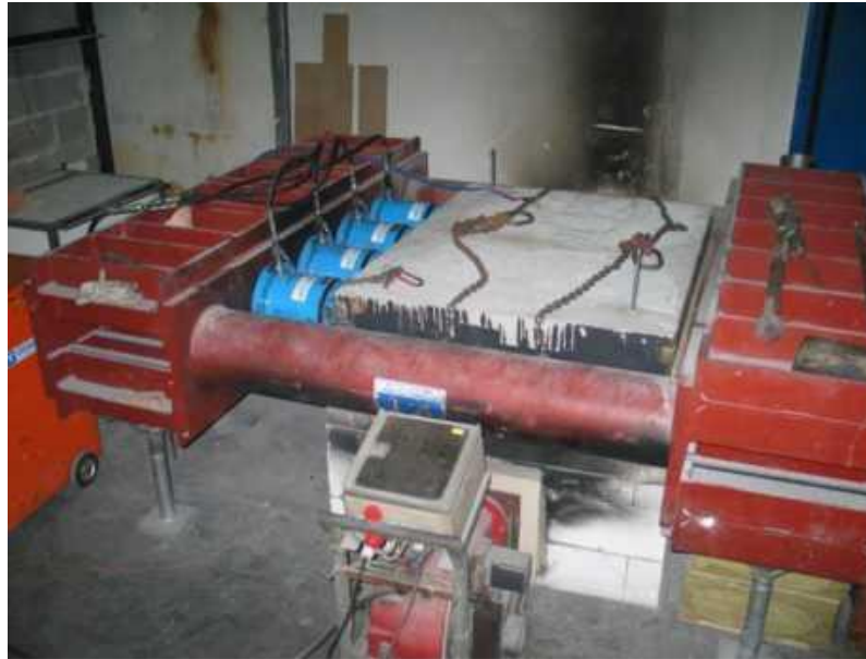
Εικόνα 18. Δοκιμή πάνελ σκυροδέματος έναντι πυρκαγιάς.[8]
