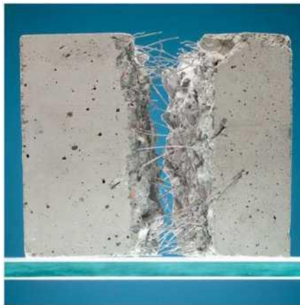
Εικόνα 15. Διατομή ινοπλισμένου σκυροδέματος.[8]
