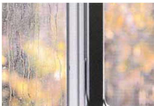
Εικόνα 6.Οαυτοκαθαριζόμενος υαλοπίνακας με επικάλυψη διοξειδίου του τιτανίου απομακρύνει το νερό της βροχής, σε αντίθεση με έναν συμβατικό.[5]
