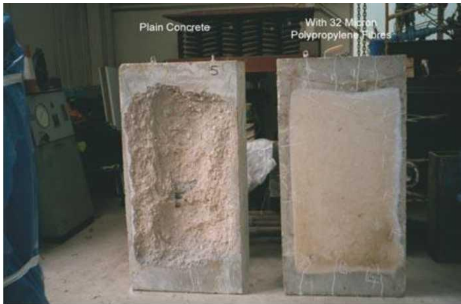
Εικόνα 17. Δοκίμια της σήραγγας της Μάγνης σε έλεγχο έναντι πυρκαγιάς(αριστερά σκυρόδεμα απλής συνθέσεως και δεξιά σκυρόδεμα ενισχυμένο με ίνες PP).[8]
