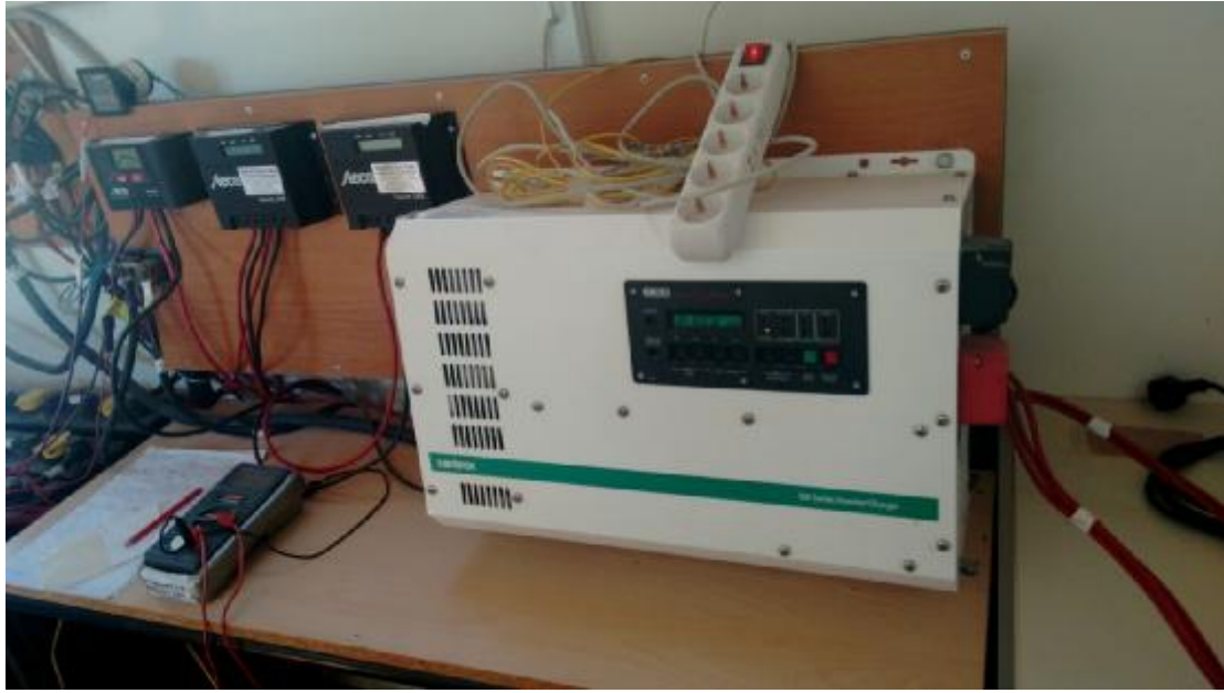
Εικόνα 5 Μετατροπέας από το ΕΡΓΑΣΤΗΡΙΟ ΑΝΑΝΕΩΣΙΜΩΝ ΠΗΓΩΝ ΕΝΕΡΓΕΙΑΣ - ΤΜΗΜΑ ΜΗΧΑΝΟΛΟΓΙΑΣ -ΤΕΙ ΔΥΤΙΚΗΣ ΕΛΛΑΔΑΣ
