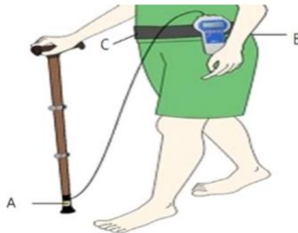
Εικόνα 3.2: η συσκευή εκπαίδευσης βάρδισης με ένα μαστούνι και αισθητήρες πίεσης.
