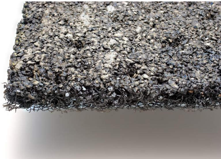
Εικόνα 42 Γεωτάπητας με σκύρα και πίσσα. Πηγή: geomuanyag.hu
