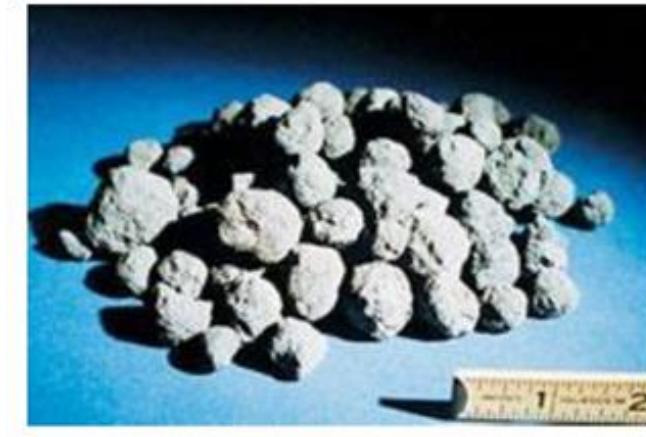
Εικόνα 2: Σφαιρίδια (pellets) μεγέθους 15-25 mm του κλίνκερ τσιμέντου (προϊόν της διεργασίας πυροσυσσωμάτωσης στην περιστροφική κάμινο).
