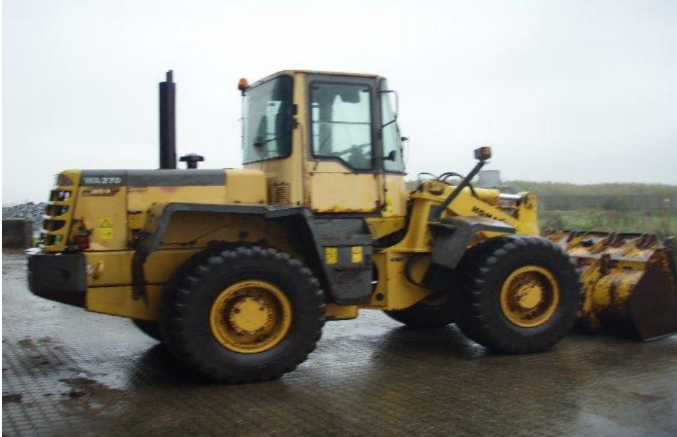
ΕΙΚΟΝΑ 3: Λαστιχοφόρος μετωπικός-αρθρωτός φορτωτής
