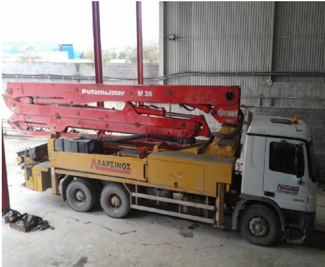
Εικόνα 2: Αντλία Μεταφοράς Σκυροδέματος
