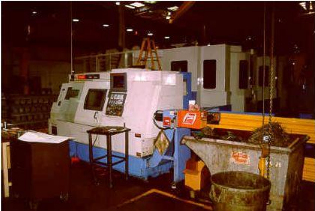
Εικόνα 14. Σύστημα αυτόματης απομάκρυνσης αποβλήτων από τις εργαλειομηχανές CNC.
