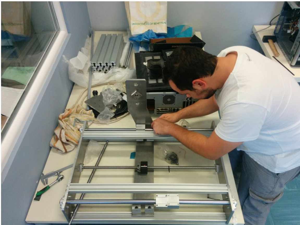
Εικόνα 11.12. Συναρμολόγηση μπράτσου εργαλειομηχανής.
