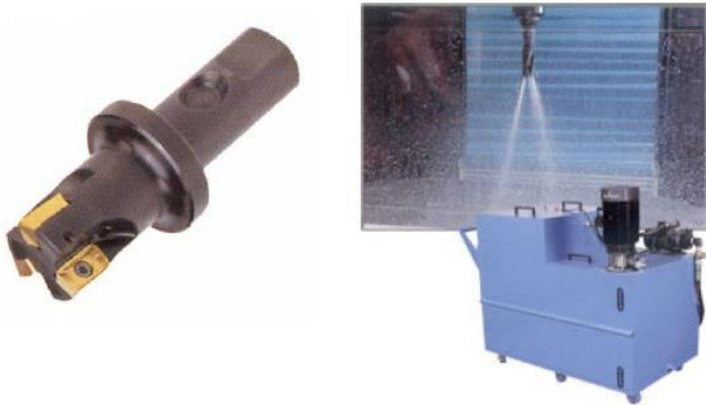
Εικόνα 13. Απευθείας παροχή υγρού κοπής στη θέση κοπής.
