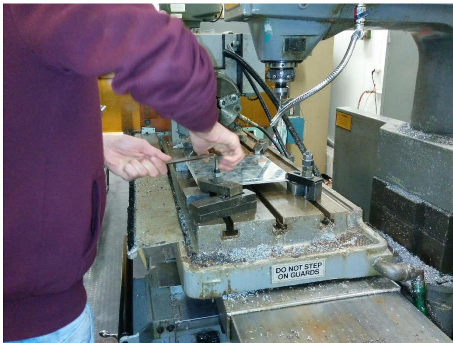
Εικόνα 11.2. Τοποθέτηση πλάκας στη CNC φρέζα.
