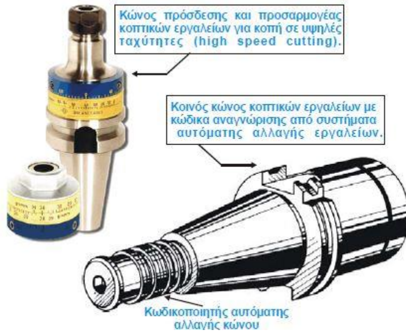
Εικόνα 15. Κώνοι CNC φρεζών.
