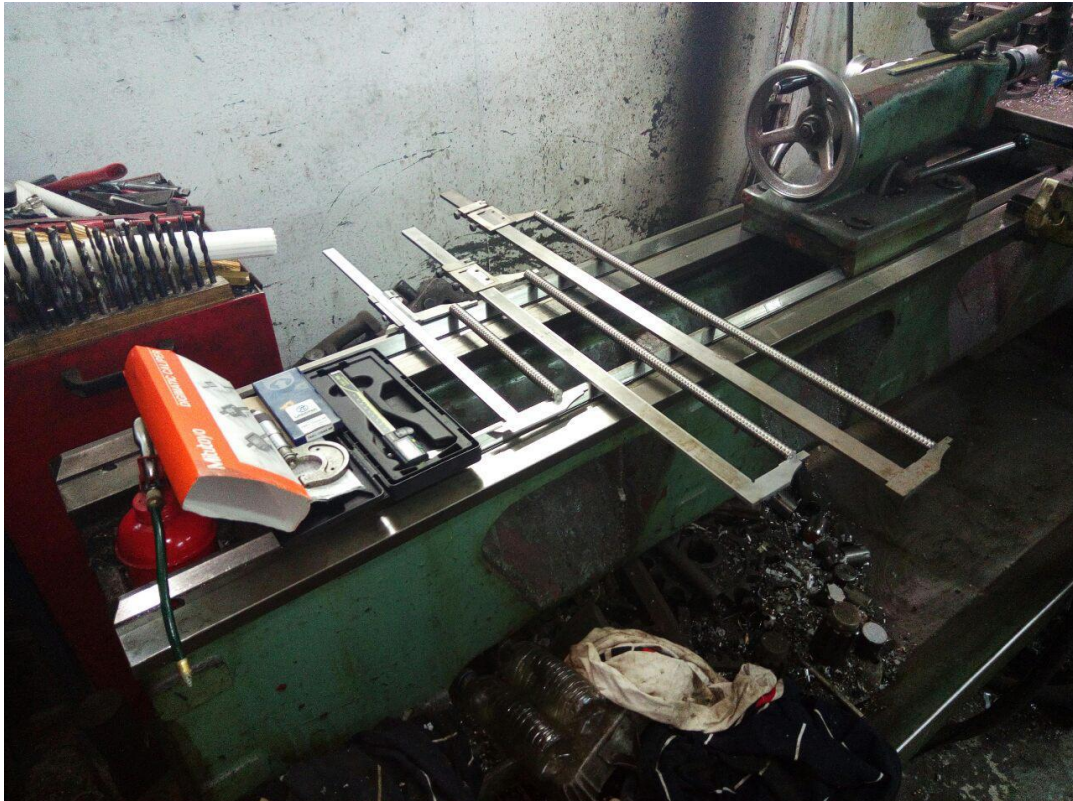
Εικόνα 11.8. Μέτρηση των Ball Screws με παχύμετρα.
