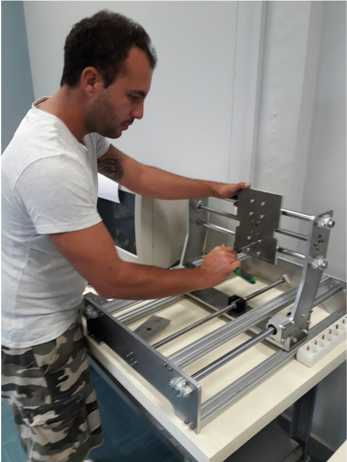
Εικόνα 11.13. Συναρμολόγηση διαμήκη άξονα.
