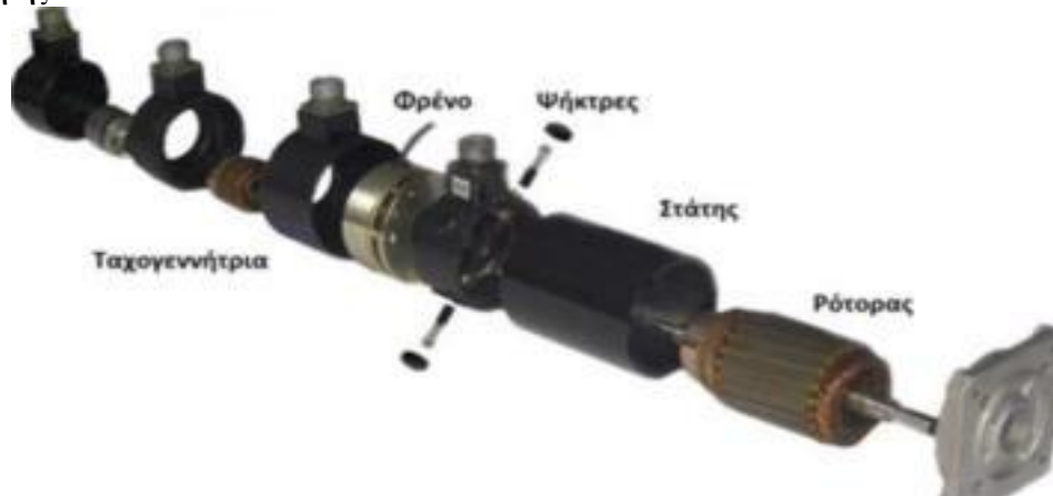
Σχήμα 1.1: Σερβοκινητήρας με σύστημα ψηκτών-συλλέκτη και ενσωματωμένο κωδικοποιητή, ταχογεννήτρια και φρένο.
