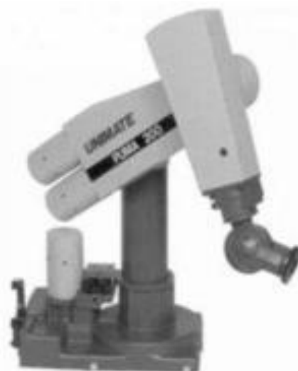
Σχήμα 1.9: Ρομποτικό σύστημα υποβοήθησης χειρουργικών επεμβάσεων PUMA 200.
