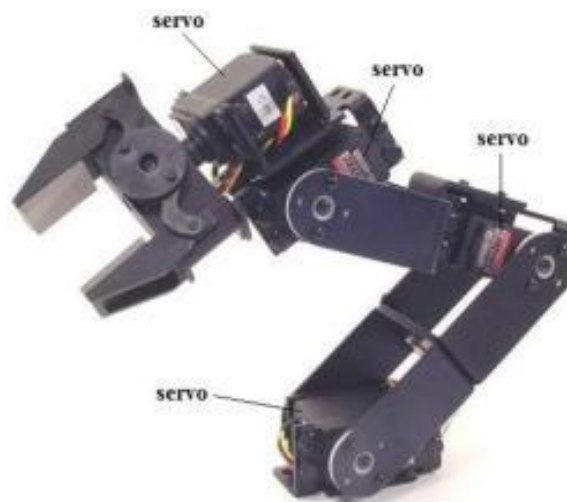
Σχήμα 1.8: Ρομποτικός βραχίονας τεσσάρων αξόνων με χρήση RC servo.
