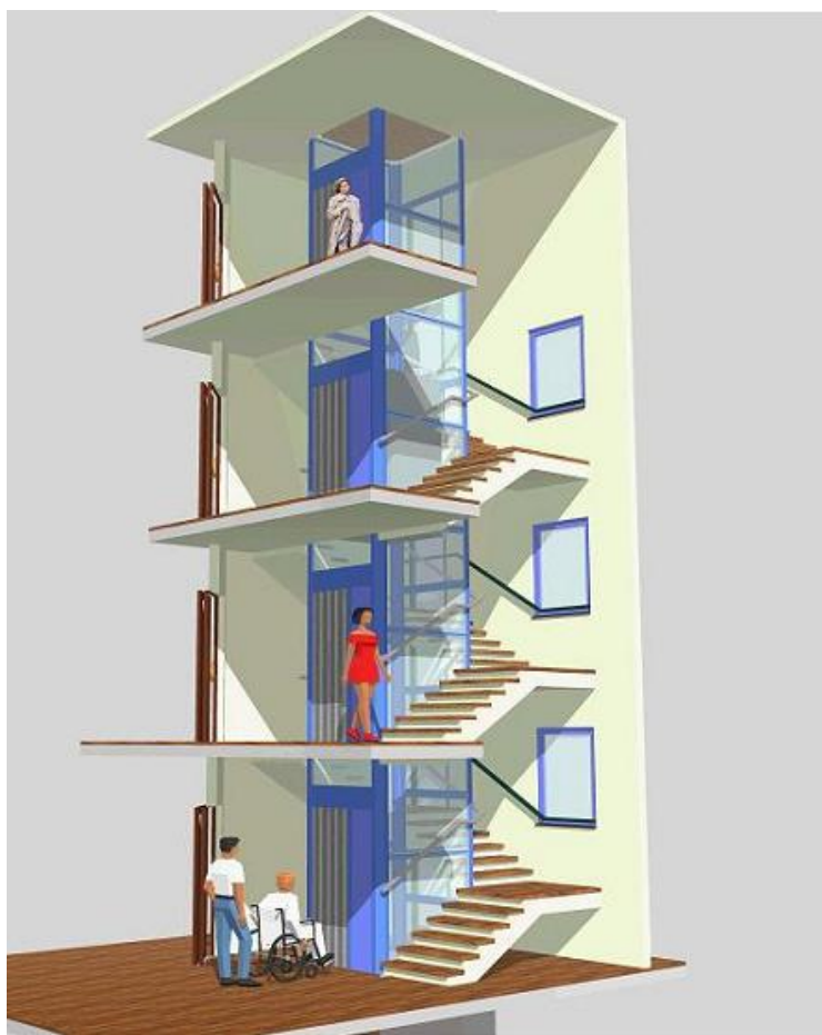
Εικόνα 4.1: Ανελκυστήρας σε οικοδομή 3 ορόφων
