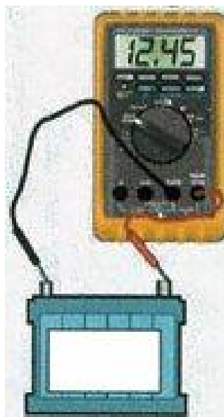
Εικόνα 33:Μέτρηση μπαταρίας με βολτόμετρο
