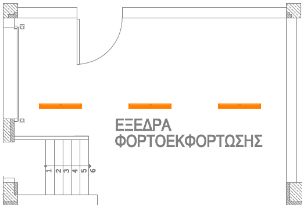
Εικόνα 4-14. Κάτοψη του χώρου φορτοεκφόρτωσης με τη διαρρύθμιση των φωτιστικών σωμάτων του
