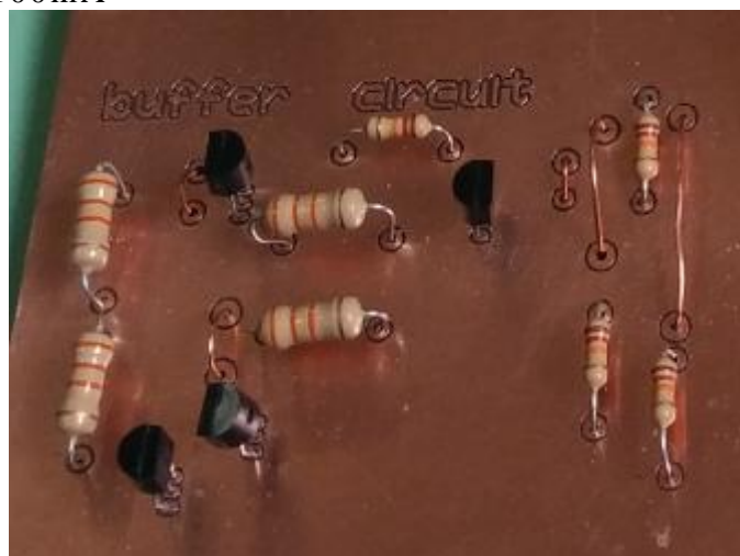
Εικόνα 22: Τα τέσσερα BJT τρανζίστορ BC547 πάνω στην πλακέτα
