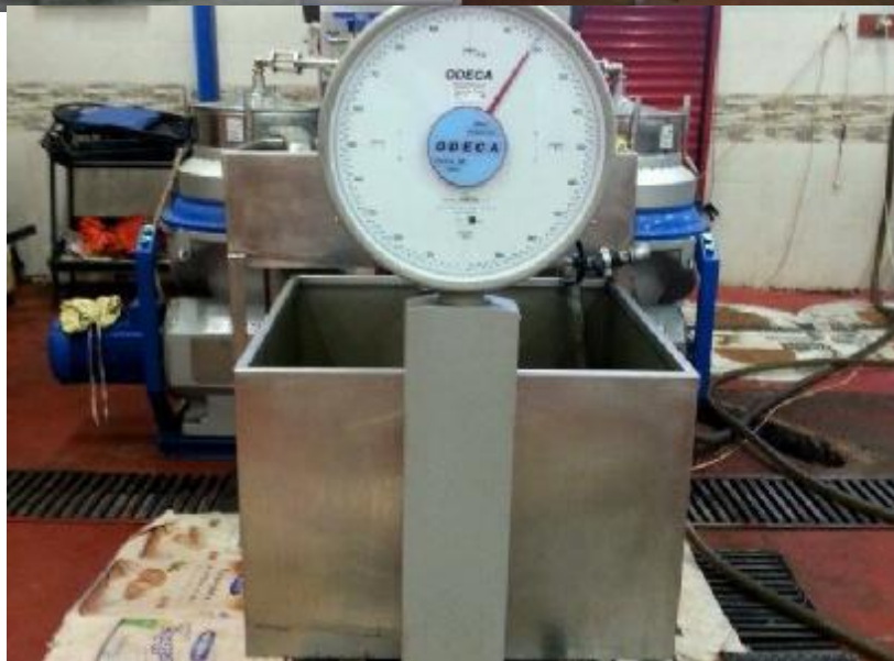
Εικόνα 4-5: Σύστημα αυτόματης μέτρησης καρπού Πηγή : Ελαιοτριβείο Ξανθός
