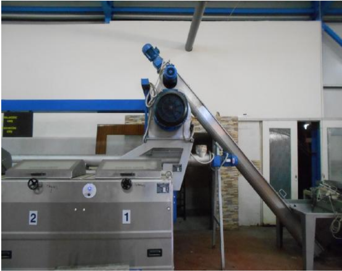
Εικόνα 3: Μεταφορική ταινία στην οποία ο καρπός μετακινείται προς τον σπαστήρα όπου αναφέραμε. Πηγή: Ελαιοτριβείο Ξανθός
