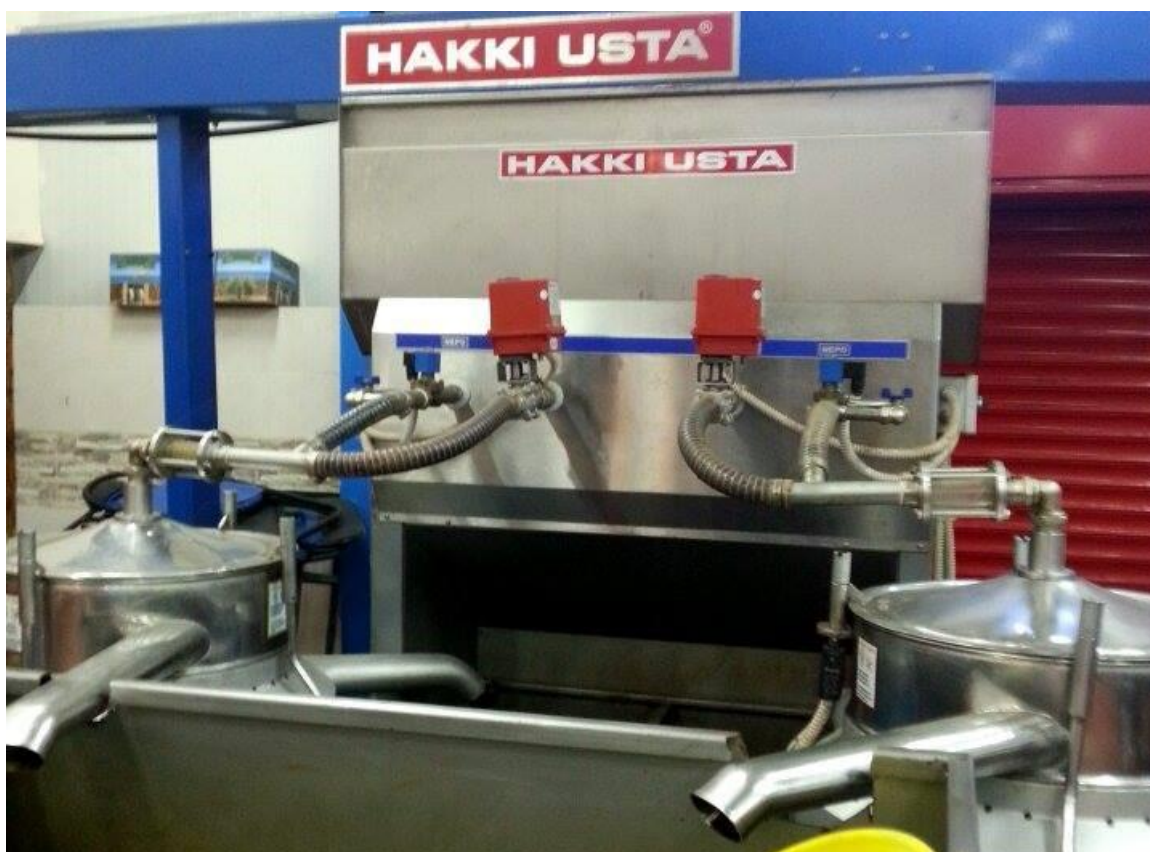
Εικόνα 7 : Τελευταίο στάδιο διαχωρισμού λαδιού από το νερό
