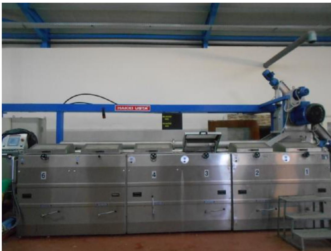
Εικόνα 6: Μαλακτήρας του ελαιοτριβείου από την εταιρία HAKKIUSTA Πηγή: Ελαιοτριβείο Ξανθός
