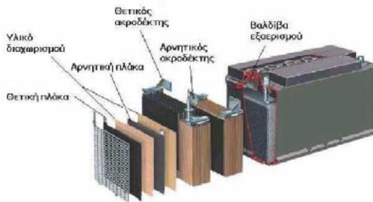
Σχήμα 4.2. Η δομή ενός συσσωρευτή.
