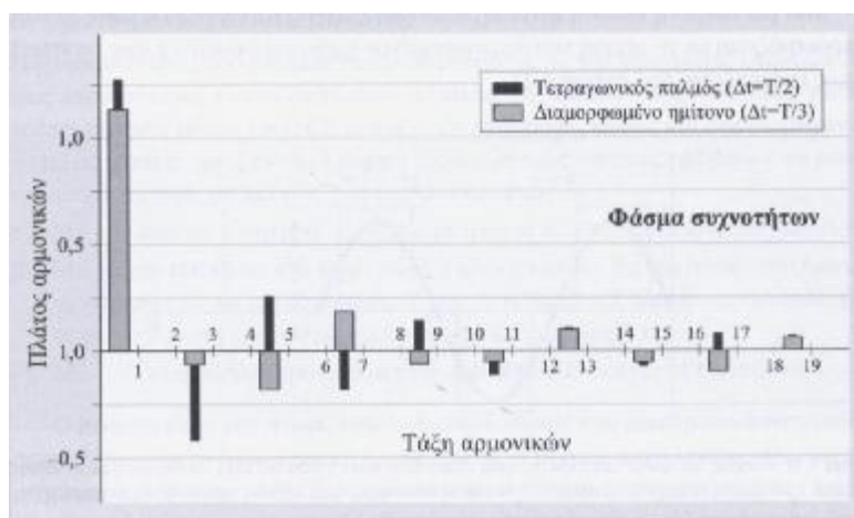
Σχήμα 5.6. Φάσμα συχνοτήτων δύο περιοδικών σημάτων, του εναλλασσόμενου τετραγωνικού παλμού (μαύρα παραλληλόγραμμα) και του εναλλασσόμενου διαμορφωμένου τετραγωνικού παλμού. Το πλάτος της θεμελιώδους αρμονικής (τάξη n=1 ) είναι \sim 1,15 του πλάτους του τετραγωνικού παλμού
