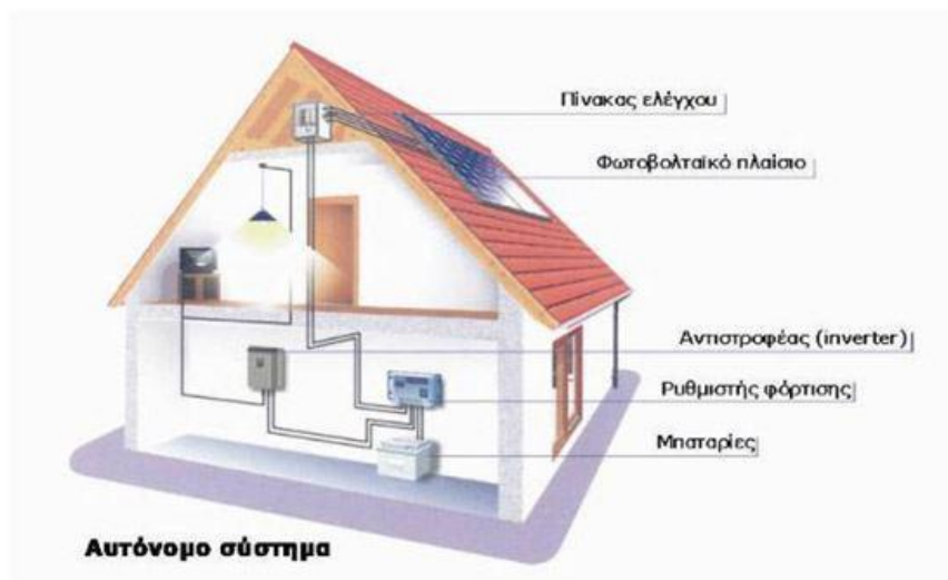
Σχήμα 1.13. Αυτόνομο Φ/Β σύστημα.
