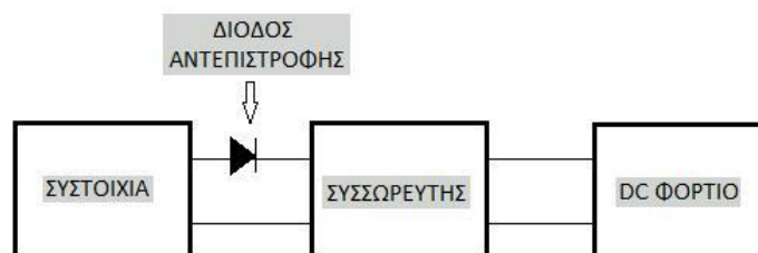
Σχήμα 5.1. Αυτορυθμιζόμενο φωτοβολταϊκό σύστημα. [24]
