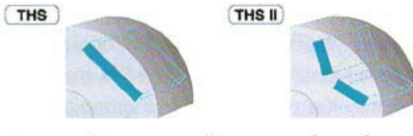
Η προηγούμενη και η νέα βελτιωμένη διάταξη των μαγνητών νεοδυμίου στον ηλεκτροκινητήρα
