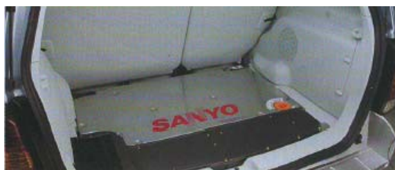
Η μπαταρία Νικελίου – Υβριδίου Μετάλλου (NiMH) του Escape Hybrid
