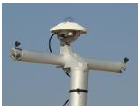
Εικόνα : Πυρανόμετρο μέτρησης της άμεσης ηλιακής ακτινοβολίας
