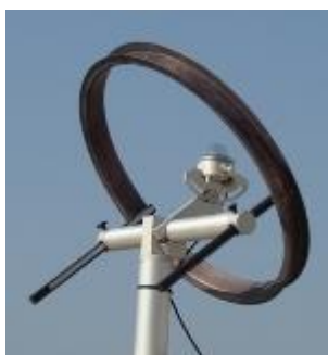
Εικόνα: Πυρανόμετρο υπολογισμού της διάχυτης ηλιακής ακτινοβολίας
