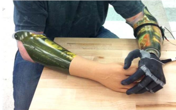
Εικόνα 4.4 Μυοηλεκτρική λειτουργική πρόθεση (Dalley et al.,2014)
