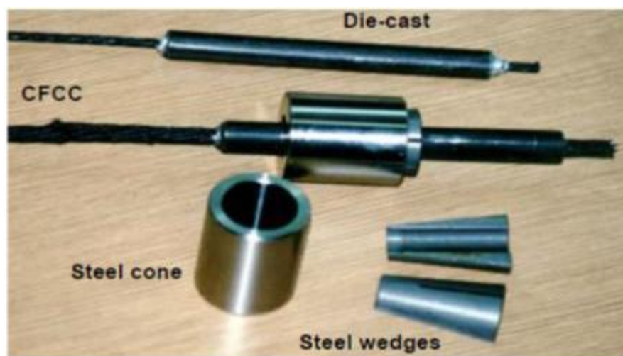
Εικόνα 2.5: Ενδεικτικά συστήματα αγκυρώσεως τενόντων [παρ.58].
