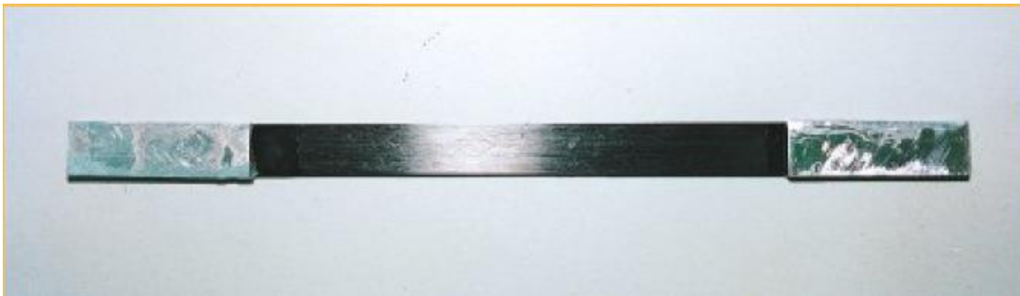
Εικόνα 1.7: Δείγμα ΙΟΠ για τον προσδιορισμό της εφελκυστικής αντοχής του [παρ.18]
