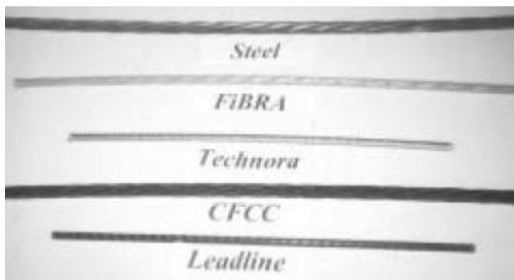
Εικόνα 2.3: Μορφές τενόντων από χάλυβα και ΙΟΠ [παρ.54]
