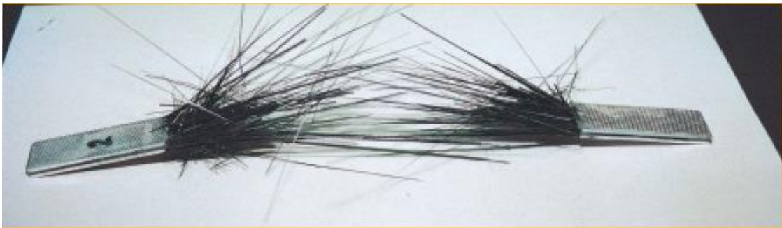
Εικόνα 1.9: Αστοχία δείγματος ΙΟΠ [παρ.21]
