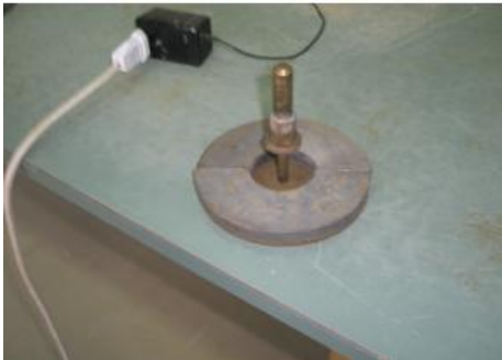
Εικόνα 15: Βάρη επιφόρτισης [Πηγή: Βγενοπούλου Ε. κ.α., 2013]
