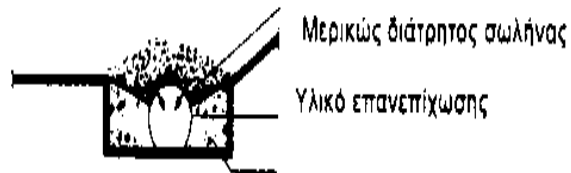
Σχήμα 52: Μερικώς διάτρητος αγωγός (Επανεπίχωση με συνεκτικό υλικό)
