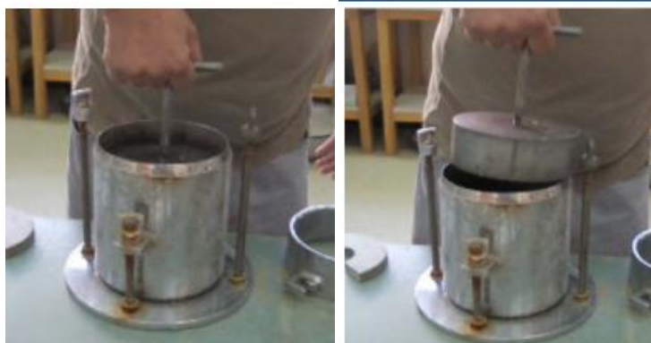
Εικόνα 9: Παρέβλημα [Πηγή: Βγενοπούλου Ε. κ.α., 2013]
