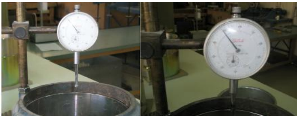
Εικόνα 13: Μηκυνσιόμετρα [Πηγή: Βγενοπούλου Ε. κ.α., 2013]
