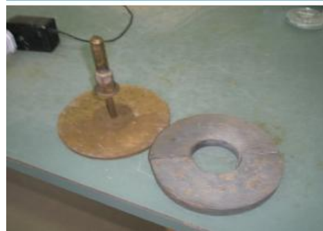
Εικόνα 14: Βάρη επιφόρτισης [Πηγή: Βγενοπούλου Ε. κ.α., 2013]
