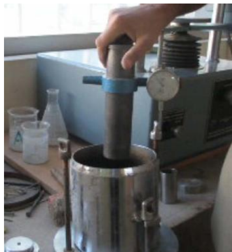
Εικόνα 16: Έμβολο διείσδυσης [Πηγή: Βγενοπούλου Ε. κ.α., 2013]
