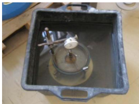
Εικόνα 18: Δοχείο υδρεμποτισμού [Πηγή: Βγενοπούλου Ε. κ.α., 2013]
