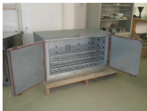
Εικόνα 19: Κλίβανος ξήρανσης [Πηγή: Βγενοπούλου Ε. κ.α., 2013]
