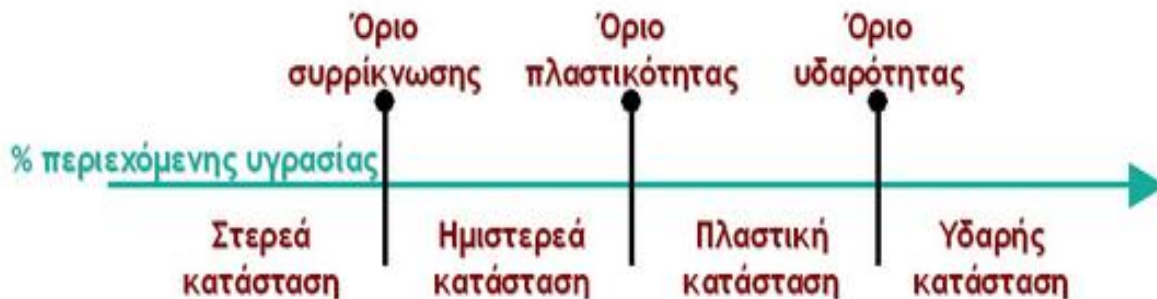
Σχήμα 11: Βαθμιαία μεταβολή των μηχανικών χαρακτηριστικών ενός συνεκτικού εδάφους με την αύξηση του ποσοστού υγρασίας.
