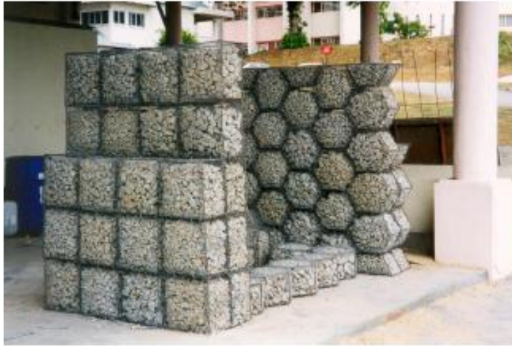
Σχ. 2.4 Διαφορετικοί τύποι συρματοκιβωτίων που κατασκευάστηκαν για την δοκιμή
