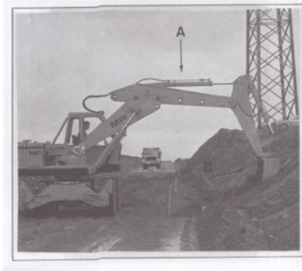
Εικόνα 22. Α. Πρόβολος Β.Κάδος Υδραυλική εξάρτηση εκσκαφής
