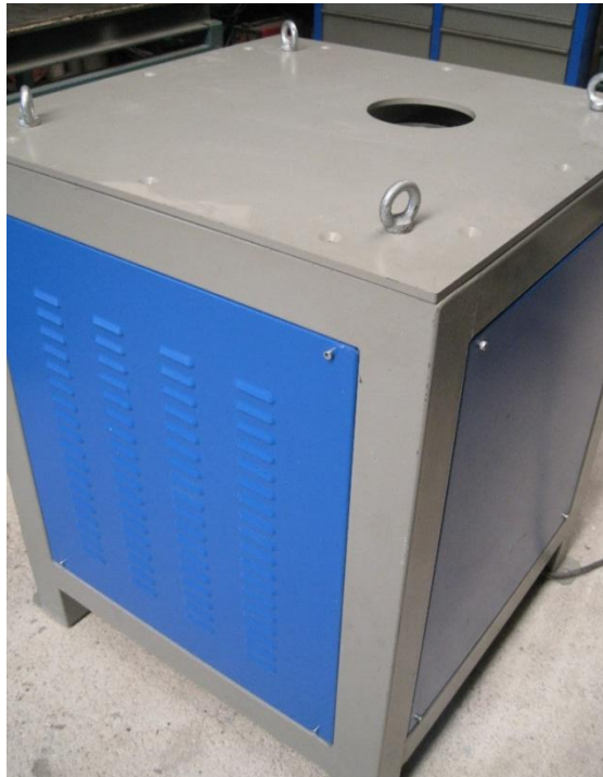
Εικόνα 42: Κουρμπαδόρος με τοποθετημένα τα εξωτερικά καλύμματα
