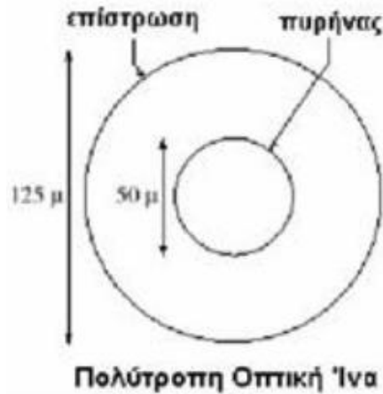
Εικόνα 16: Τομή πολύτροπης οπτικής ίνας
