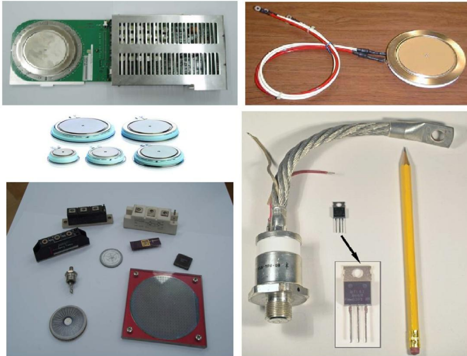
Σχήμα 2.12: Ημιαγωγοί: thyristor, IGCT, GTO, IGBT κ.α..
