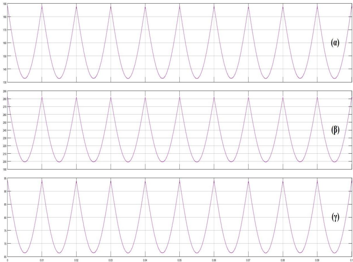
Σχήμα 5.19: Πραγματικοί παλμοί (α), Παλμοί για μέγιστο Duty Cycle (β), Παλμοί για ελάχιστο Duty Cycle (γ).
