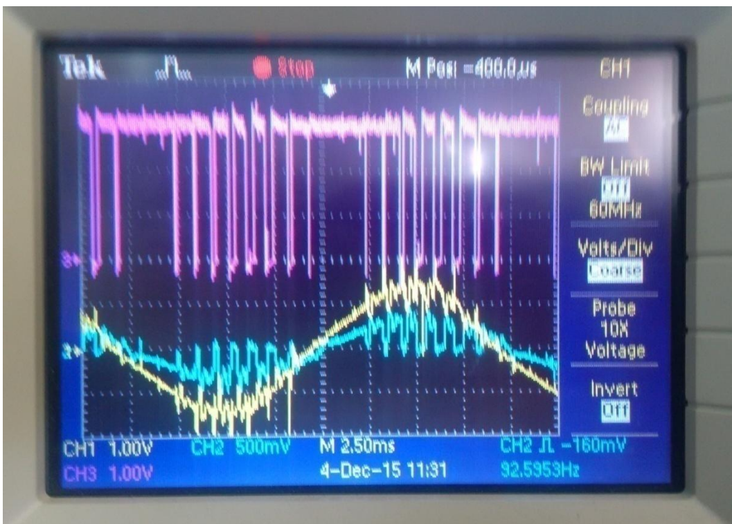
Σχήμα 7.17: Έξοδος αισθητήρα τάσης (κίτρινο), έξοδος αισθητήρα ρεύματος (μπλε) και οι παλμοί (μωβ) για μέγιστη τιμή του Duty Cycle και για σύνθετο ωμικό-επαγωγικό φορτίο.
