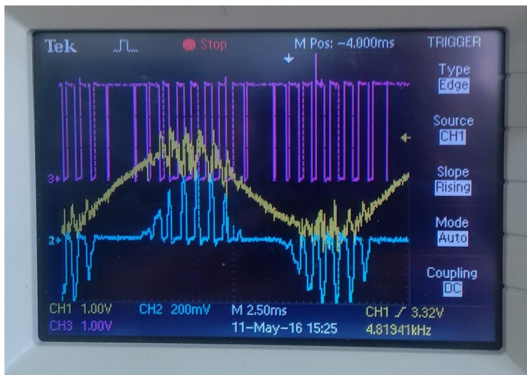
Σχήμα 7.33: Έξοδος αισθητήρα τάσης (κίτρινο), έξοδος αισθητήρα ρεύματος (μπλε) και παλμοί (μωβ) για μέγιστη τιμή του Duty Cycle με κινητήρα εν κενώ και χωρίς φίλτρο μείωσης αρμονικών.
