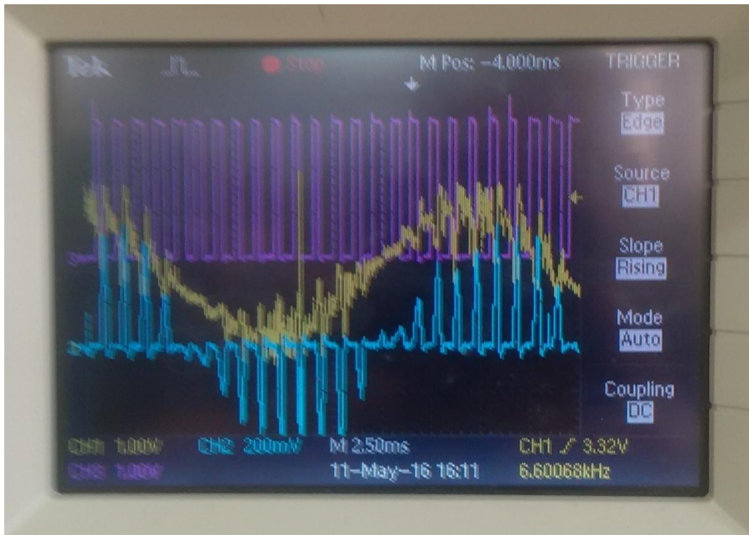
Σχήμα 7.45: Έξοδος αισθητήρα τάσης (κίτρινο), έξοδος αισθητήρα ρεύματος (μπλε) και παλμοί (μωβ) για ενδιάμεση τιμή του Duty Cycle για κινητήρα με φορτίο και χωρίς φίλτρο μείωσης αρμονικών.
