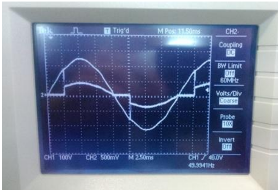
Σχήμα 5.1: Γωνία καθυστέρησης \alpha = 45^\circ σε ωμικό φορτίο.
