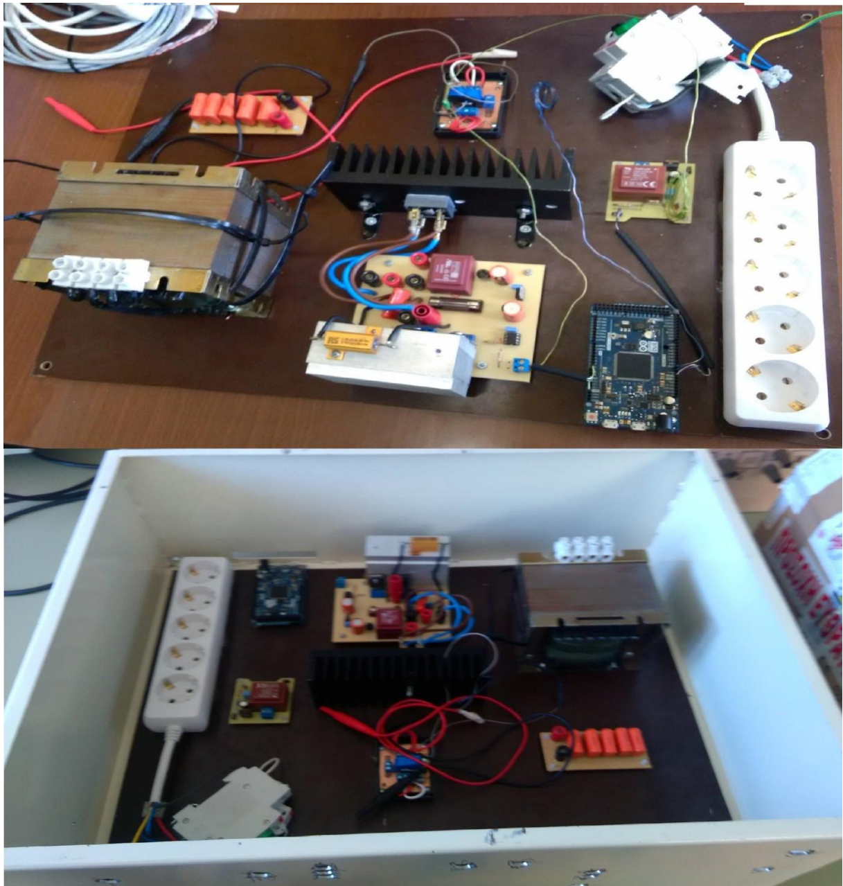
Σχήμα 6.4: Κατανομή τμημάτων του μετατροπέα στο μονωτικό υλικό και στο πλαίσιο-κουτί.
