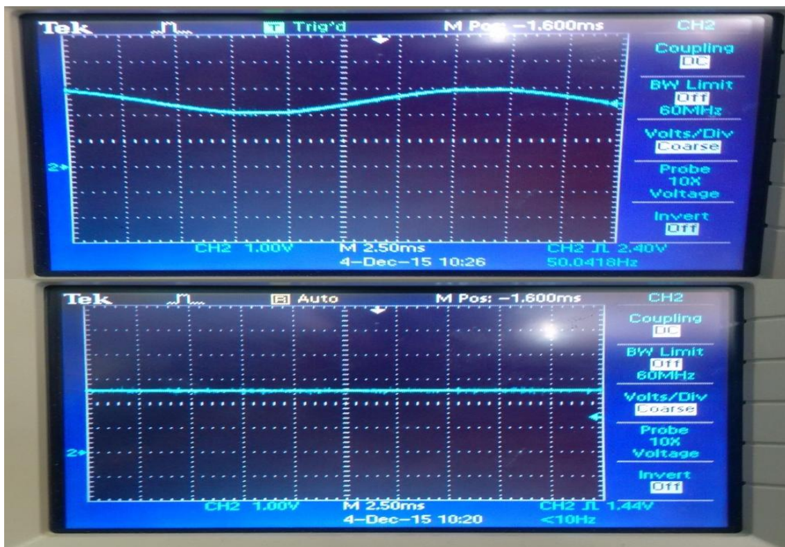
Σχήμα 4.19: Σήμα εξόδου αισθητήρα για είσοδο 6 A και DC συνιστώσα σε παλμογράφο.
