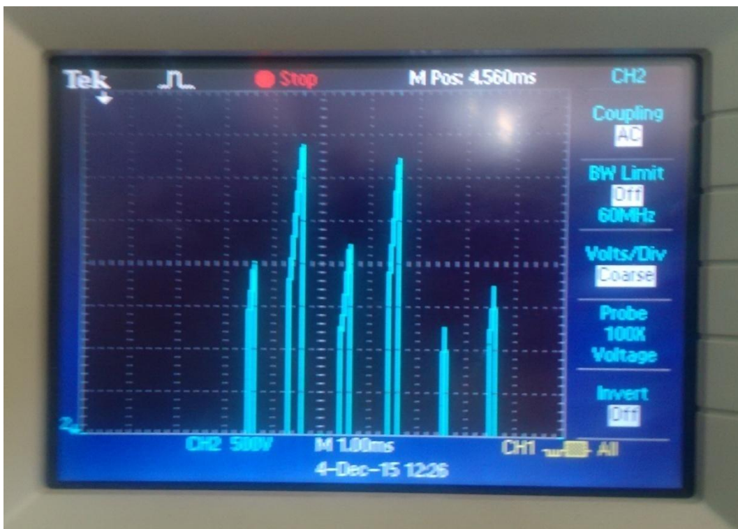
Σχήμα 7.28: Τάση ανόδου- καθόδου του IGBT για σύνθετο ωμικό-επαγωγικό φορτίο με εστίαση του παλμογράφου στις αιχμές των υπερτάσεων που εμφανίζονται στα άκρα του τρανζίστορ.
