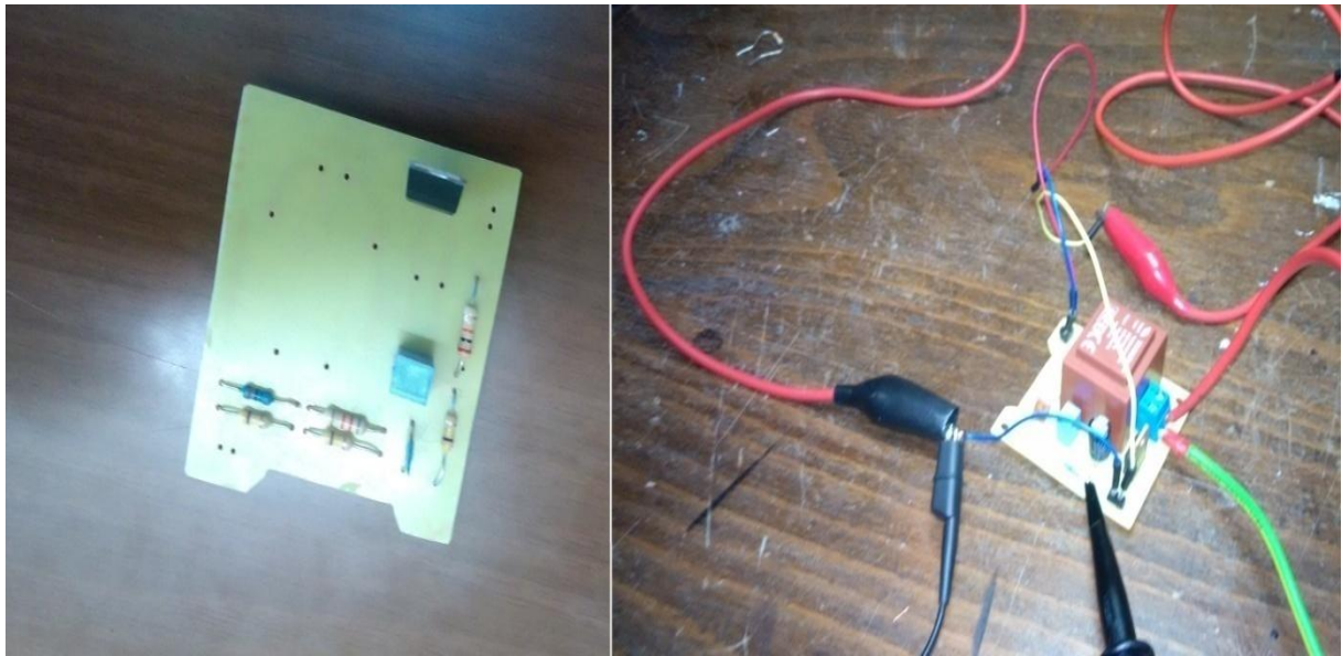
Σχήμα 4.8: Κατασκευή και δοκιμή αισθητήρα τάσης.
