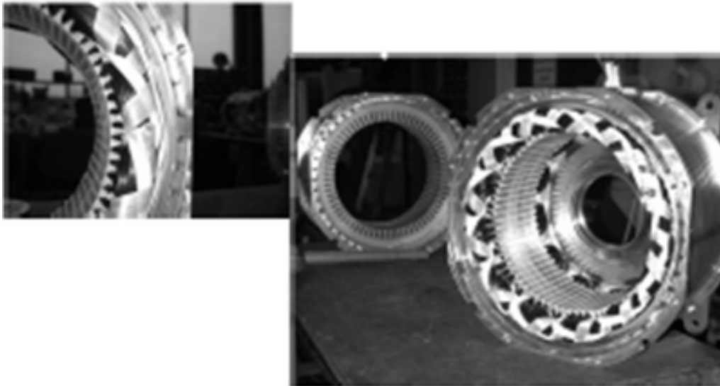
Εικόνα 6: Λεπτομέρειες στάτη: Περιλαμβάνει τα τυλίγματα των 3 φάσεων που είναι εγκλωβισμένα σε ειδικές εσοχές-αυλάκια.
