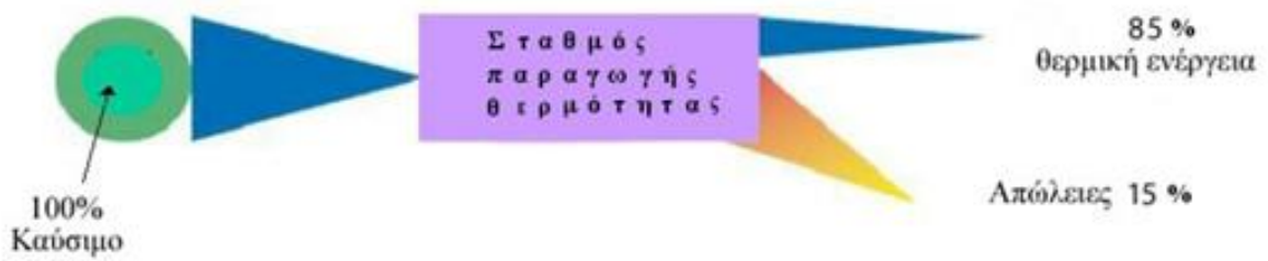
Εικόνα 2: Συμβατικό σύστημα παραγωγής θερμικής ενέργειας
