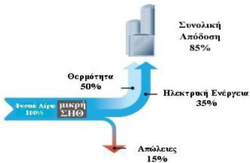
Εικόνα 3: Σύστημα συμπαραγωγής θερμικής και ηλεκτρικής ενέργειας
