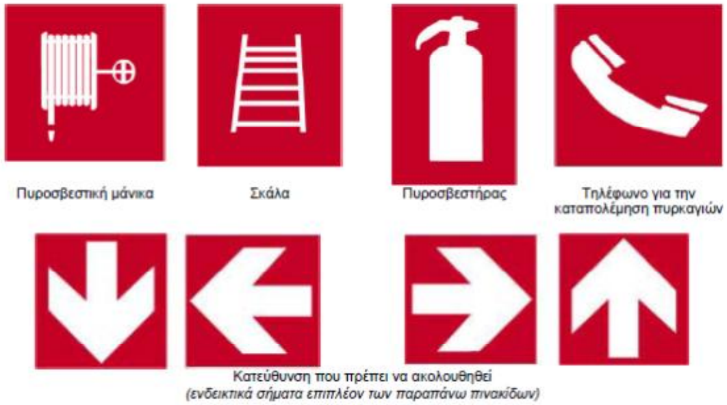
Εικόνα 13. Πινακίδες που αφορούν το πυροσβεστικό υλικό ή εξοπλισμό
