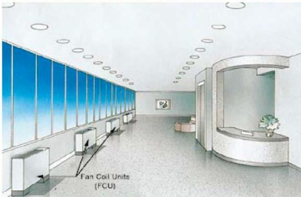
Εικόνα 2.3: Κεντρική εγκατάσταση κλιματισμού με Fan-Coils δαπέδου
