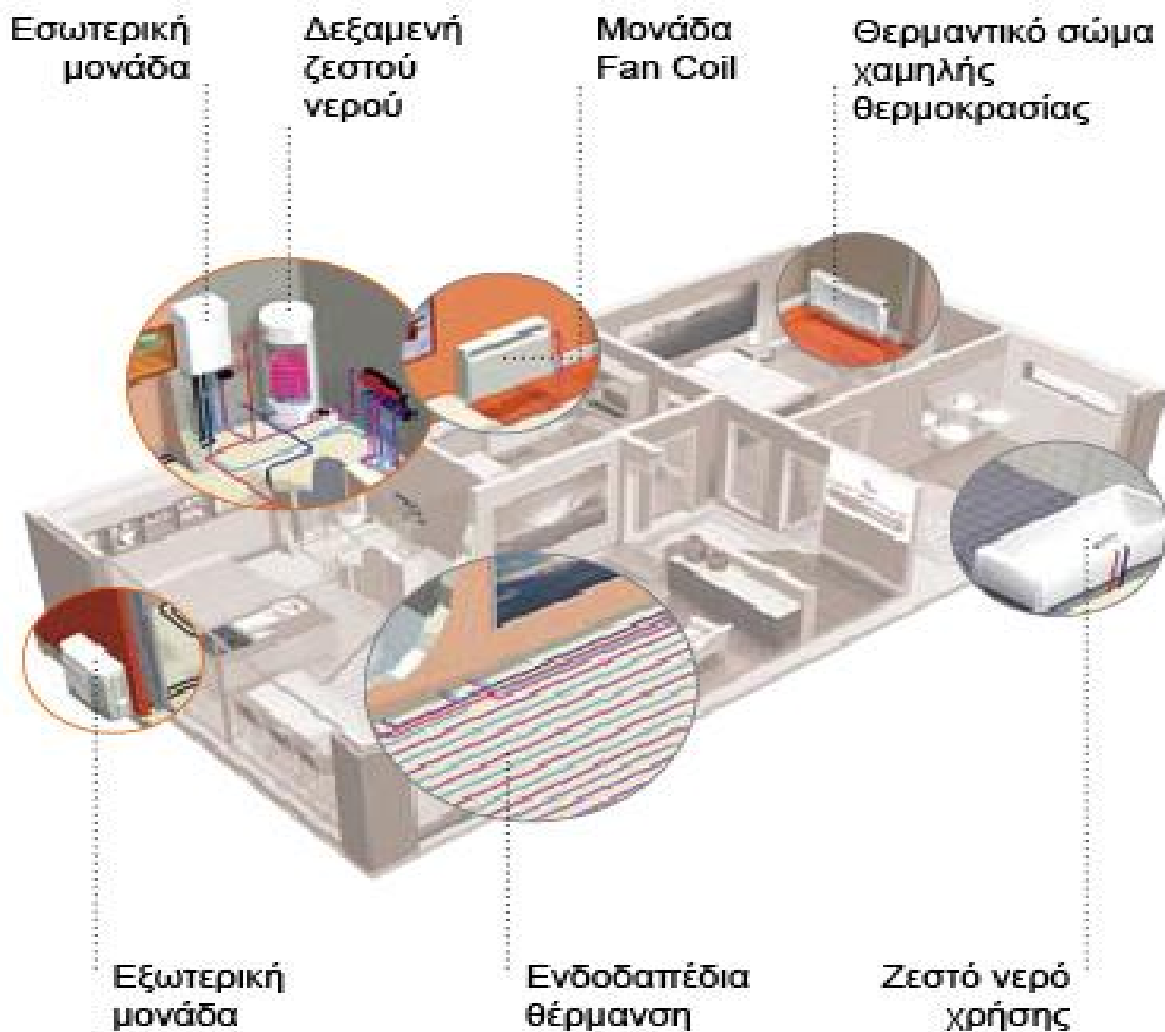
Εικόνα 2.50: Σύνδεση αντλίας θερμότητας με fan coils, ενδοδαπέδιο σύστημα θέρμανσης και ζεστό νερό χρήσης
