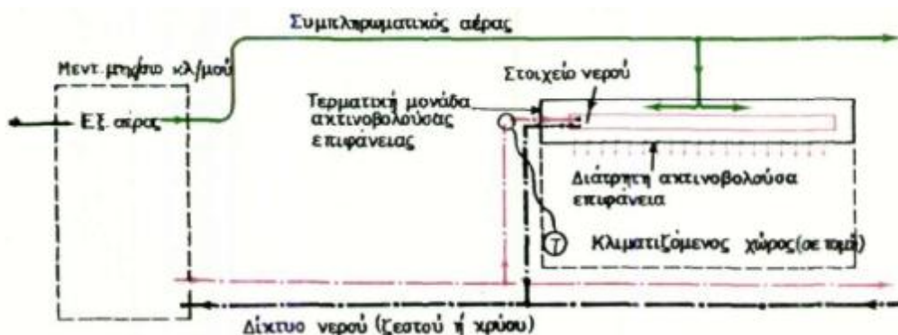
Εικόνα 2.13: Σχηματικό διάγραμμα συστήματος αέρα-νερού με τερματικές μονάδες τύπου ακτινοβόλουσας επιφάνειας και με συμπληρωματικό αέρα.
