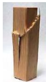
Εικόνα 22 Έδρασης υποστυλώματος αξονικά θλιβόμενου
