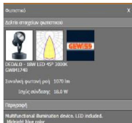
Εικόνα 1.35 Φωτιστικά που χρησιμοποιήθηκαν για τον εξωτερικό φωτισμό και τα χαρακτηριστικά τους
