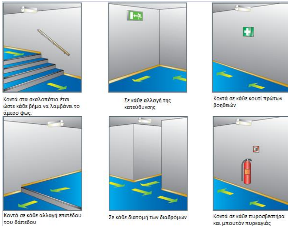
Εικόνα 1.25 Τοποθέτηση φωτιστικών στα σημεία έμφασης
