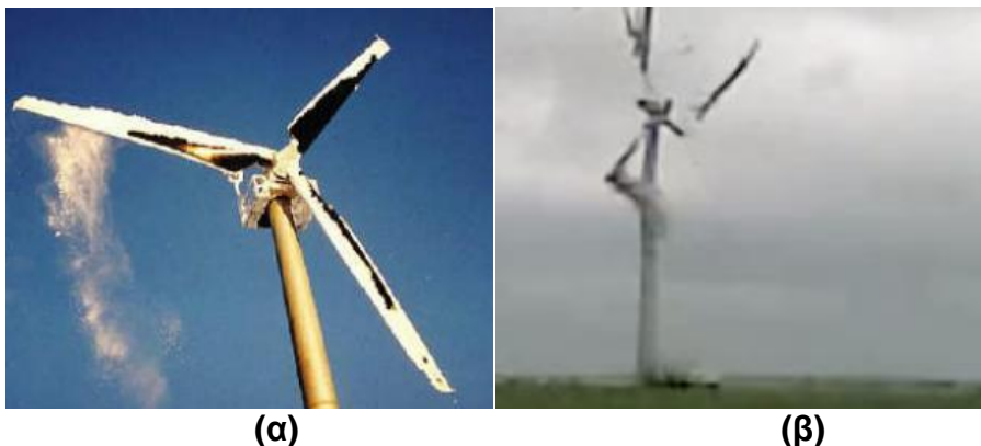
Εικόνα 8: Τα ακραία καιρικά φαινόμενα επηρεάζουν αρνητικά την λειτουργία της ανεμογεννήτριας α) παγετός β) ισχυροί άνεμοι σε ανεμογεννήτρια
