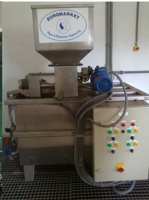
Εικόνα 4.33 Ταινιοπρέσσα για αφυδάτωση ιλύος και Εικόνα 4.34 Συσκευή για την προεπεξεργασία αφυδάτωσης με πολυηλεκτρολύτες
