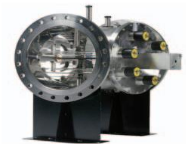
Εικόνα 2.3. Διάταξη καθαρισμού με χρήση όζοντος(O 3 )
