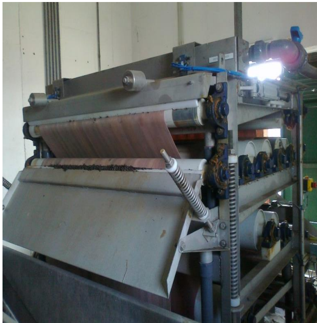
Εικόνα 4.33 Ταινιοπρέσσα για αφυδάτωση ιλύος και Εικόνα 4.34 Συσκευή για την προεπεξεργασία αφυδάτωσης με πολυηλεκτρολύτες
