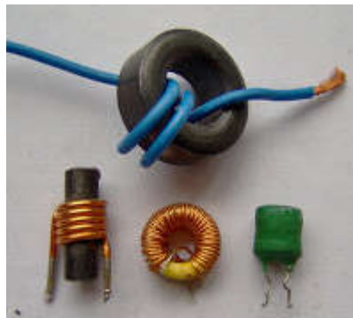
Σχήμα 2.7: Σχεδιαστικές προτάσεις για τη γρήγορη κατασκευή ενός "απλού" πηνίου.
